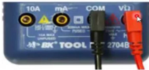
شكل رقم ٧٦: أطراف توصيل لفحص التوصيلية
