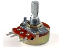
شكل رقم ٣١: المقاومة المتغيرة والدائرة المكافئة لها كمجزئ للجهد.
