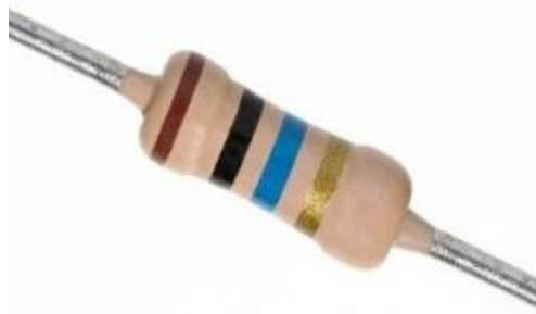
شكل رقم ٣٥: المقاومات الرباعية النطاقات اللونية
