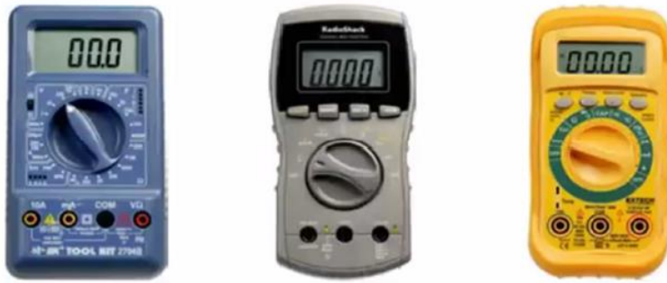
شكل رقم ٦٥: أشكال جهاز الملتيميتر (Multimeter) (الأفوق)
