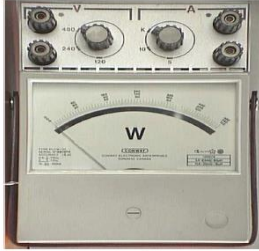
شكل رقم ٦٦: جهاز قياس القدرة الواط ميتر
