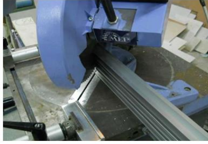
شكل رقم ٥٢: عملية قص القطاعات بالمنشار الدائري
