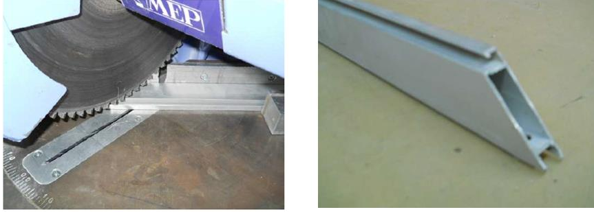
شكل رقم ٧٠: عملية قص القطاع بالمنشار الدائري
