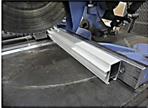
شكل رقم ٤٥: عملية قطع التميرين بالمنشار الدائري
