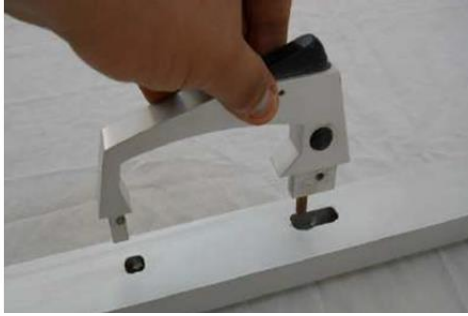
شكل رقم ٦٦: عملية ثقب القطاع العمودي الشكل وتركيب المقبض به
