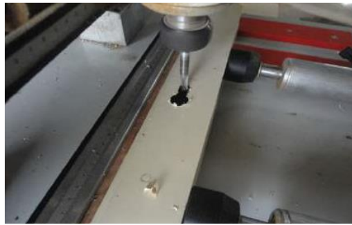
شكل رقم ١٠: عملية تفريز قلب كالون
