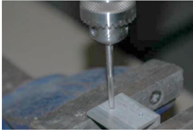
شكل رقم ٥٦: عملية قلوطة ثقب الزاوية
