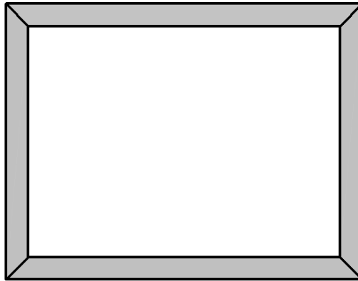
شكل رقم ٨٤: عملية تجميع الحلق بالكامل
