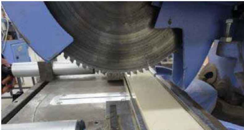
شكل رقم ٢٧: عملية قطع التمرين بالمنشار الدائري
