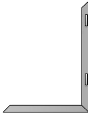
شكل رقم ٦٨: عملية تجميع الركن الأول للدرفة
