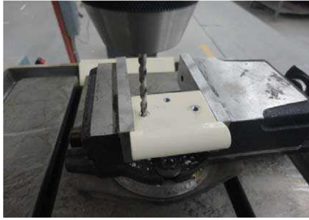
شكل رقم ٣٤: عملية ثقوب جناحي المفصلة
