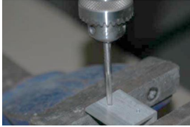
شكل رقم ٦٣: عملية قلوطة ثقوب الزاوية
