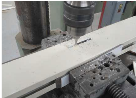
شكل رقم ٣٠: عملية تفريز القطاعات
