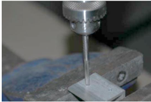
شكل رقم ٨٠: عملية قلوطة ثقوب الزاوية
