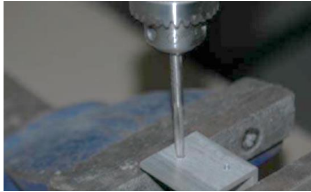
شكل رقم ٤٤: عملية قلوطة ثقب الزاوية
