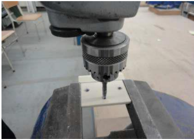
شكل رقم ٣٥: عملية قلوطة ثقوب جناحي المفصلة
