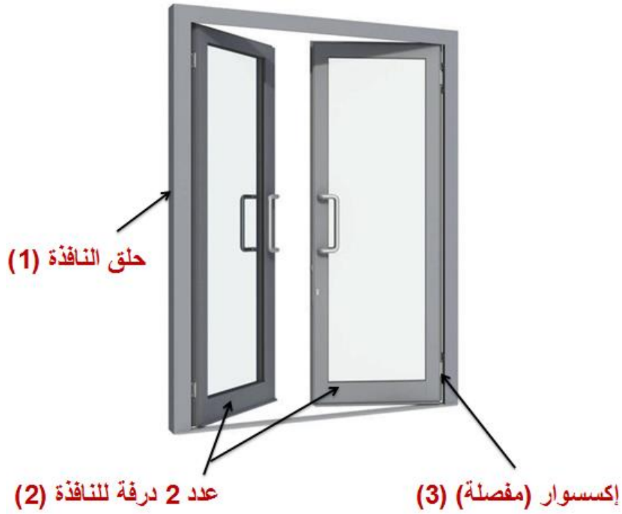
شكل رقم ٦: المكونات الأساسية للنافذة المفصلية
