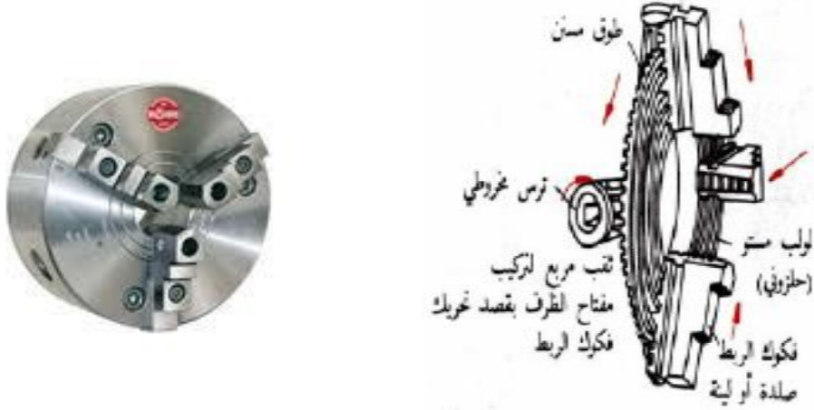
شكل (١٢) الظرف المركزي ذي ثلاث فكوك Three-jaw
