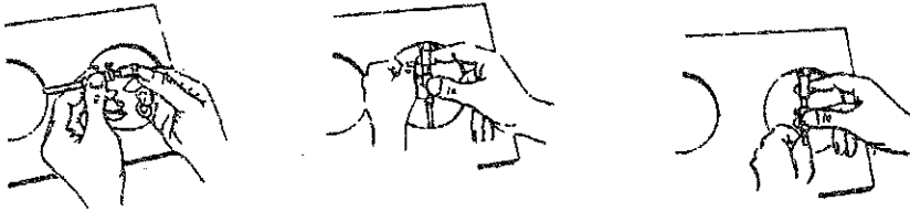
شكل (٣-١٩) طريقة استعمال الميكرومتر الداخلى
