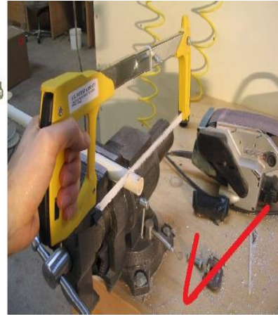
شكل رقم ٨٥: الأوضاع الصحيحة والخاطئة لسلاح المنشار أثناء النشر
