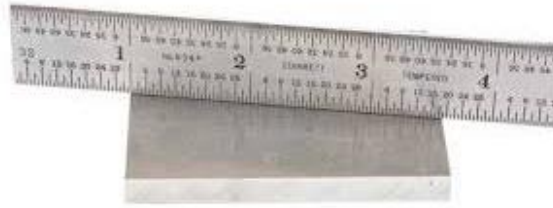
شكل رقم ١٢٧: قياس استوائية السطح باستخدام حافة المسطرة
