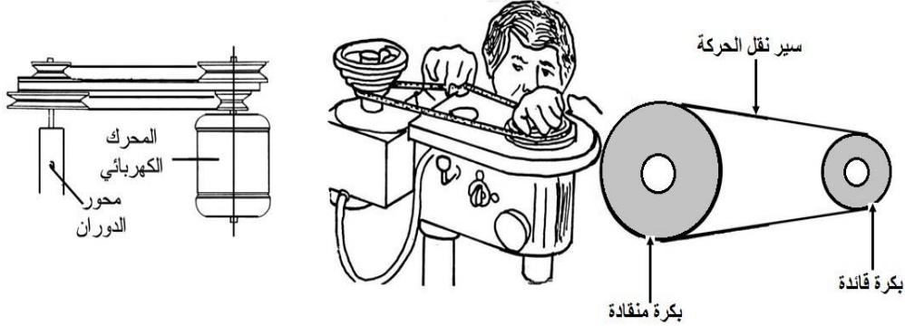
شكل رقم ١٥٤: ضبط سرعة دوران محور الثقب
