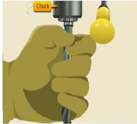
شكل رقم ١٦٧: تركيب البينة وأربطها بمفتاح الظرف
