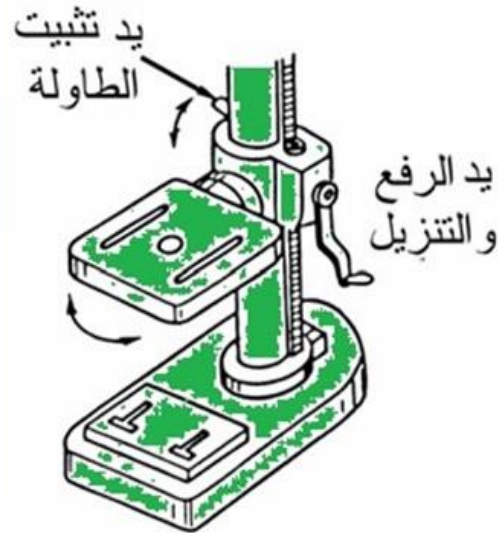
شكل رقم ١٦٥: ضبط ارتفاع الطاولة
