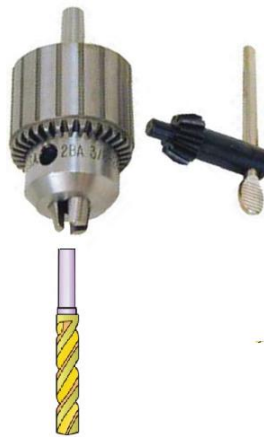
شكل رقم ١٩٨: تركيب ريشة لتنعيم واربطها بمفتاح الظرف
