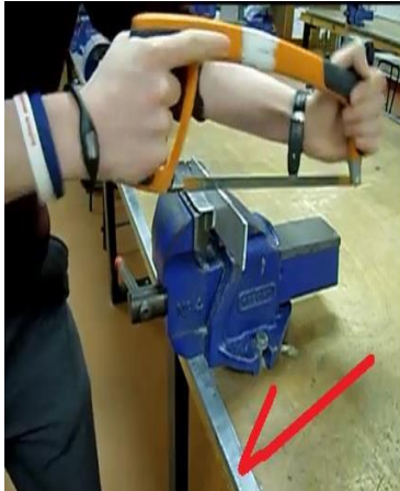
شكل رقم ٨٥: الأوضاع الصحيحة والخاطئة لسلاح المنشار أثناء النشر
