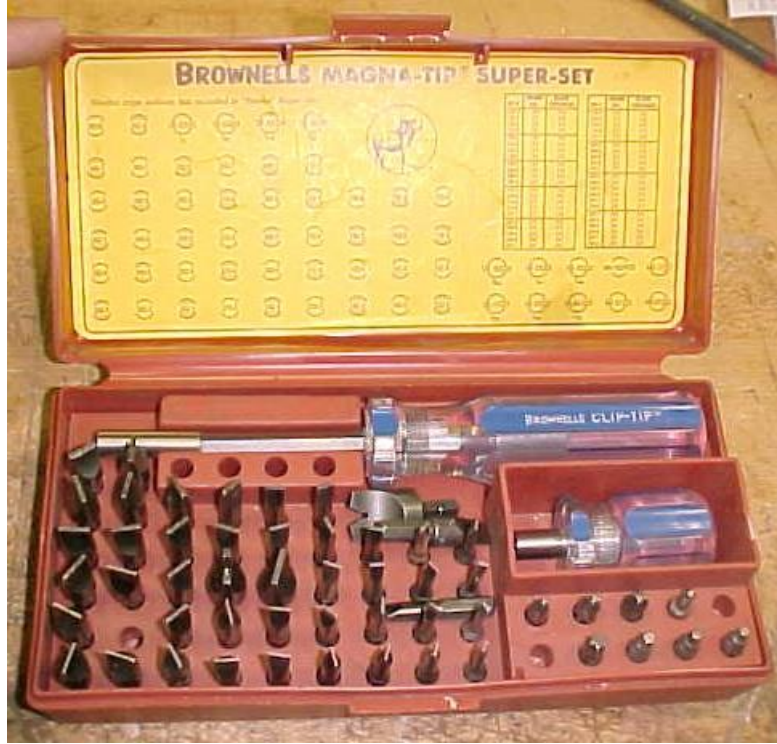
شكل رقم ٦: طقم المفكات ذو اللقم المختلفة (لقم عادة وصلبية ومثلثة وسداسية ... الخ)
