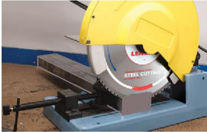
شكل رقم ١٠٧ : تثبيت قطعة الشغل
