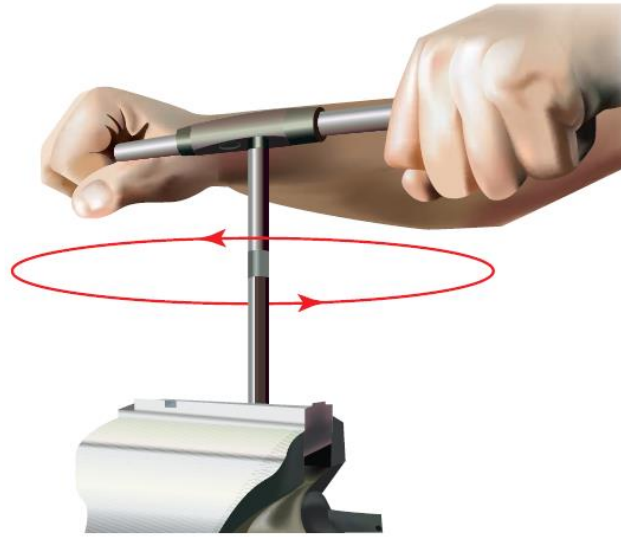
شكل رقم ١٨٥: لف البوجي للاتجاه المعاكس بمقدار نصف لفة
