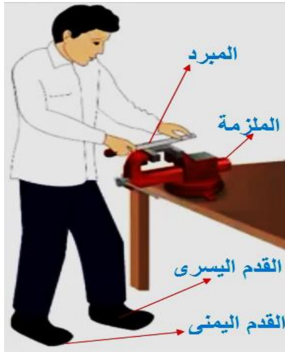
شكل رقم ١١٦: الوضع الصحيح للقدمين أثناء إجراء البرادة.
