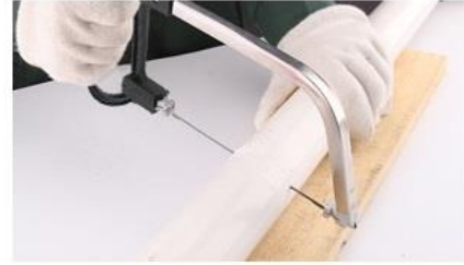
شكل رقم ٧٣: عملية نشر قطع مختلفة باستخدام منشار التخريم اليدوي
