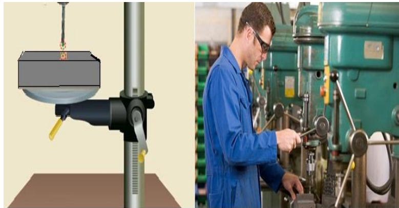
شكل رقم ١٦٨: التأكد من مركزية البينة مع مركز الثقب المطلوب
