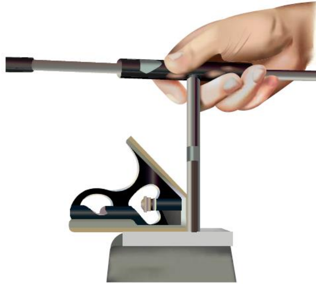
شكل رقم ١٨٣: ضبط تعامد ذكر القلاووظ
