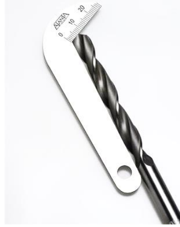
شكل رقم ١٦٦: فحص زاوية رأس البينة بالمنقلة ومحدد المثقاب
