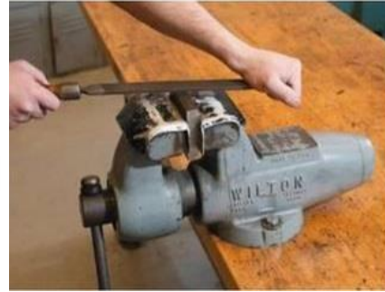
شكل رقم ١١٧: الطريقة الصحيحة للإمساك بالمبرد أثناء عمل برادة للأسطح.
