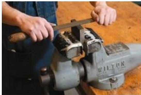
شكل رقم ١١٨: الطريقة الصحيحة للضغط بالمبرد على قطعة الشغل.
