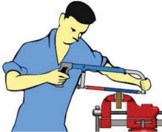
شكل رقم ٨٢: كيفية مسك المنشار بكلتا اليدين
