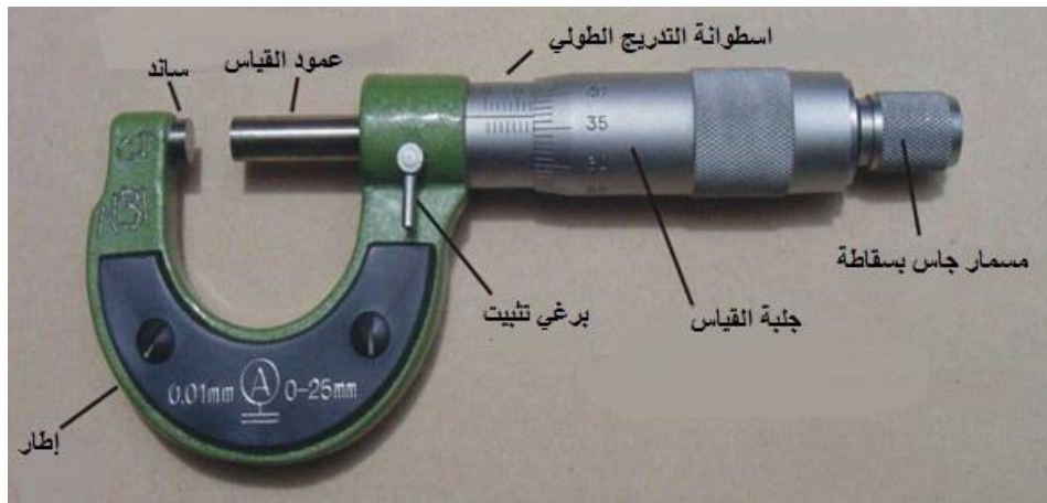
شكل رقم ٤٥: المكونات الرئيسية للميكرومتر.
