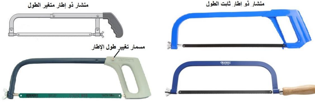
شكل رقم ٦٨: منشار المعادن اليدوي ذو الإطارين ثابت ومتغير الطول
