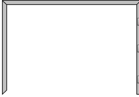
شكل رقم ٣٧: عملية تجميع الركن الثاني للحلق الواجهة
