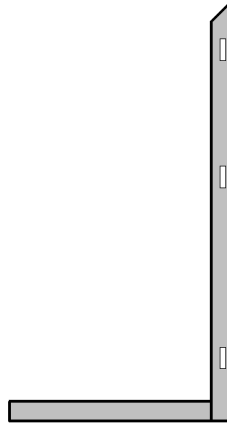
شكل رقم ٦٣: عملية تجميع الركن الأول للدرفة
