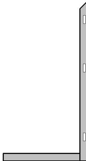
شكل رقم ٤٣: عملية تجميع الركن الأول للدرفة
