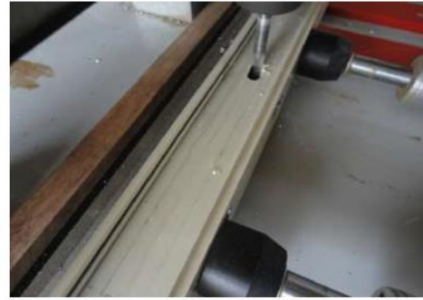
شكل رقم ٦١: عملية تفريز أماكن تركيب الكالون بالدرفة
