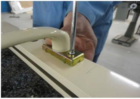
شكل رقم ٤٢: عملية تركيب الكالون بالدرفة
