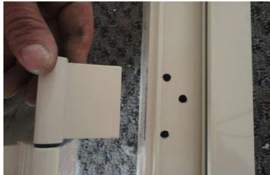
شكل رقم ٦٧: عملية نسخ الثقوب
