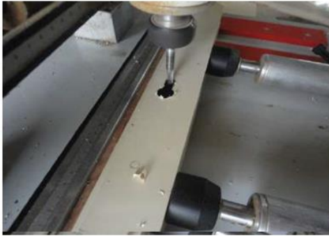
شكل رقم ٦١: عملية تفريز أماكن تركيب الكالون بالدرفة
