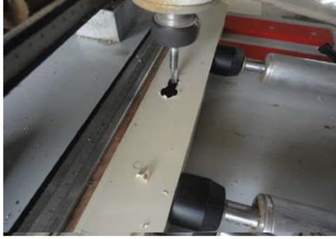
شكل رقم ٤١: عملية تفريز أماكن تركيب الكالون بالدرفة
