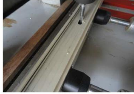
شكل رقم ٤١: عملية تفريز أماكن تركيب الكالون بالدرفة
