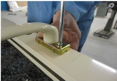
شكل رقم ٦٢: عملية تركيب الكالون بالدرفة
