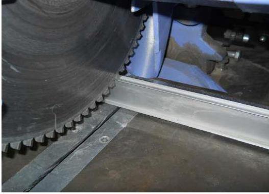
شكل رقم ١٠: عملية قص قطاع كلييس الكوبسته وقاعدة الدرازين
