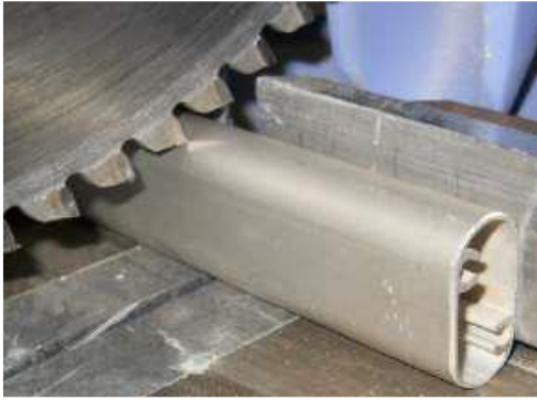
شكل رقم ٥٢: عملية قص قطاع أعمدة الدرايزين
