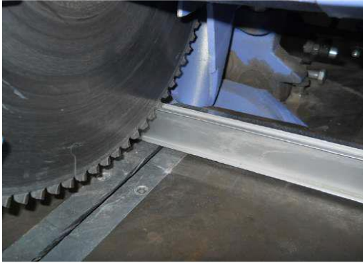
شكل رقم ٣٧: عملية قص قطاع كلييس الكوبستة وقاعدة الدرابزين
