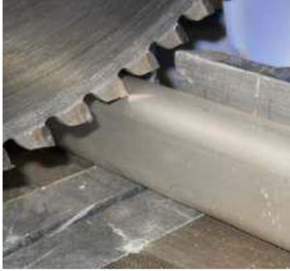
شكل رقم ١١: عملية قص قطاع أعمدة الدرازين
