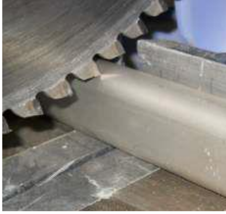
شكل رقم ٢٣: عملية قص قطاع أعمدة الدرايزين
