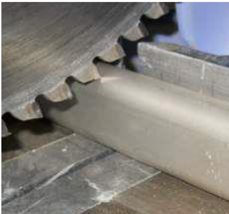
شكل رقم ٣٨: عملية قص قطاع أعمدة الدرابزين
