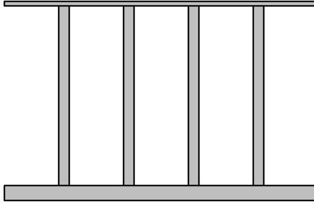
شكل رقم ٥٦: عملية تجميع أعمدة الدرابزين مع الضلع الأفقيين
