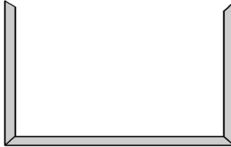
شكل رقم ٧٨: عملية تجميع الركن الثاني لحلق النافذة
