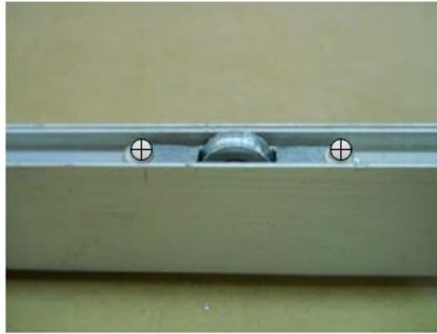
شكل رقم ٦٢: عملية تفريز أماكن العجلات وتركيبها
