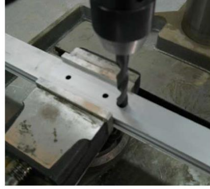
شكل رقم ٨١: عملية ثقب القطاع العمودي الشكل وتركيب المقبض به
