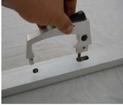
شكل رقم ٨١: عملية ثقب القطاع العمودي الشكل وتركيب المقبض به
