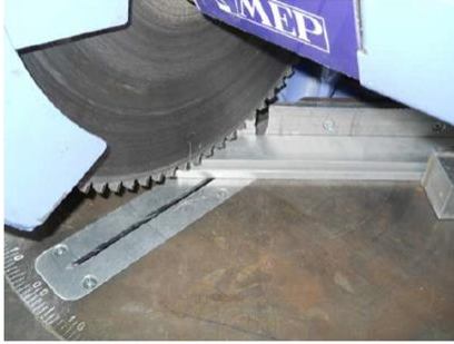
شكل رقم ٤٦: عملية قص القطاع بالمنشار الدائري
