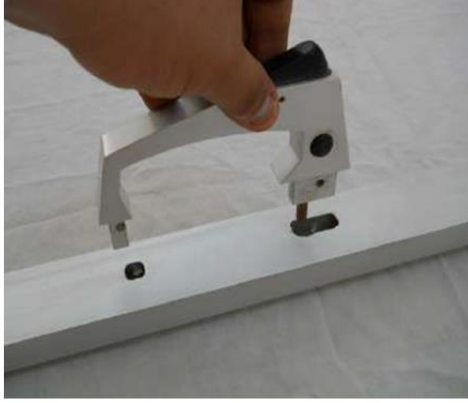
شكل رقم ٤٠: عملية ثقب القطاع العمودي للشنكل وتركيب المقبض به
