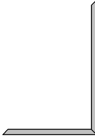
شكل رقم ٥٧: عملية تجميع الركن الأول للحلق
