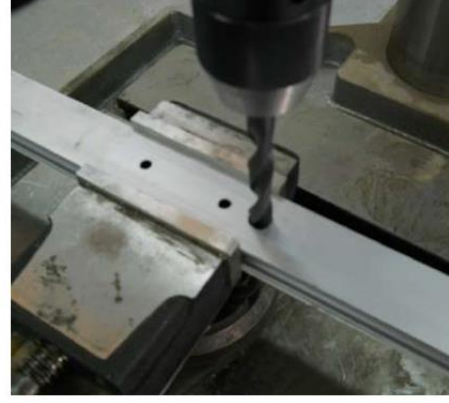
شكل رقم ٤٠: عملية ثقب القطاع العمودي للشنكل وتركيب المقبض به
