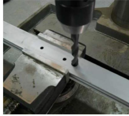
شكل رقم ٦١: عملية ثقب القطاع العمودي الشنكل وتركيب المقبض به
