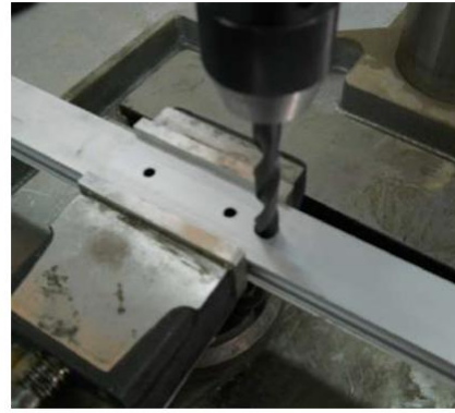
شكل رقم ٩٦: عملية ثقب القطاع العمودي الشكل وتركيب المقبض به
