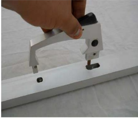
شكل رقم ٦١: عملية ثقب القطاع العمودي الشنكل وتركيب المقبض به
