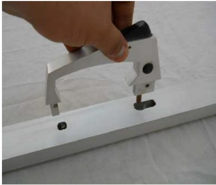
شكل رقم ٩٦: عملية ثقب القطاع العمودي الشكل وتركيب المقبض به
