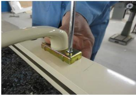
شكل رقم ٦٤: عملية تركيب الكالون بالدرفة
