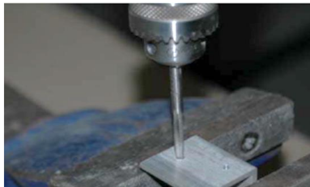
شكل رقم ٣٠: عملية قلوطة ثقوب الزاوية
