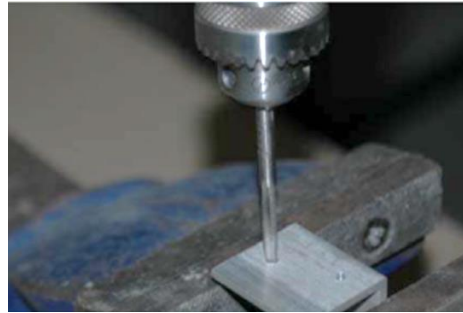
شكل رقم ٥٨: عملية قلوطة ثقوب الزاوية
