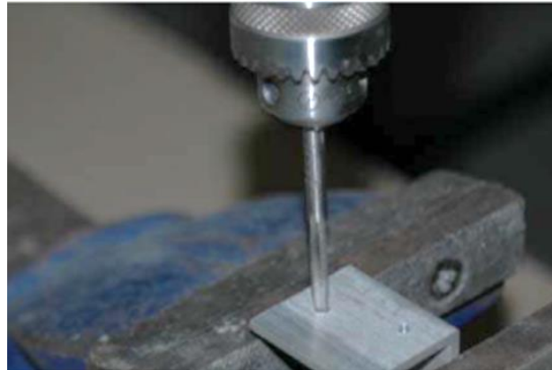
شكل رقم ٩١: عملية قلوطة ثقب الزاوية
