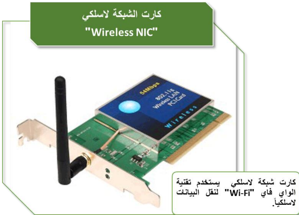
شكل رقم ٨: كارت الشبكة لاسلكي (واي فاي "Wi-Fi")
