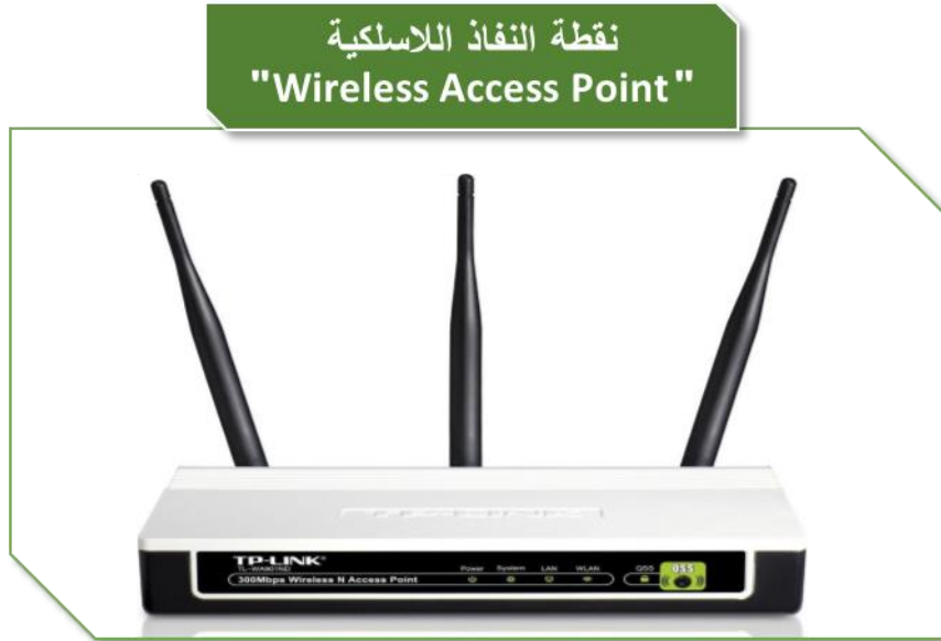
شكل رقم ٢٧: نقطة النفاذ اللاسلكية "Wireless Access Point"
