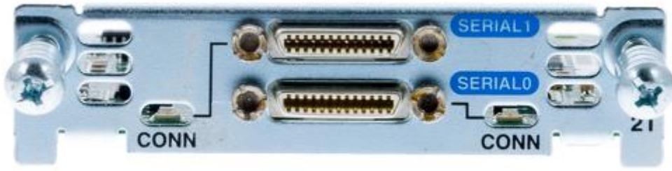
شكل رقم ١٢٧: كارت المنافذ التسلسلية
