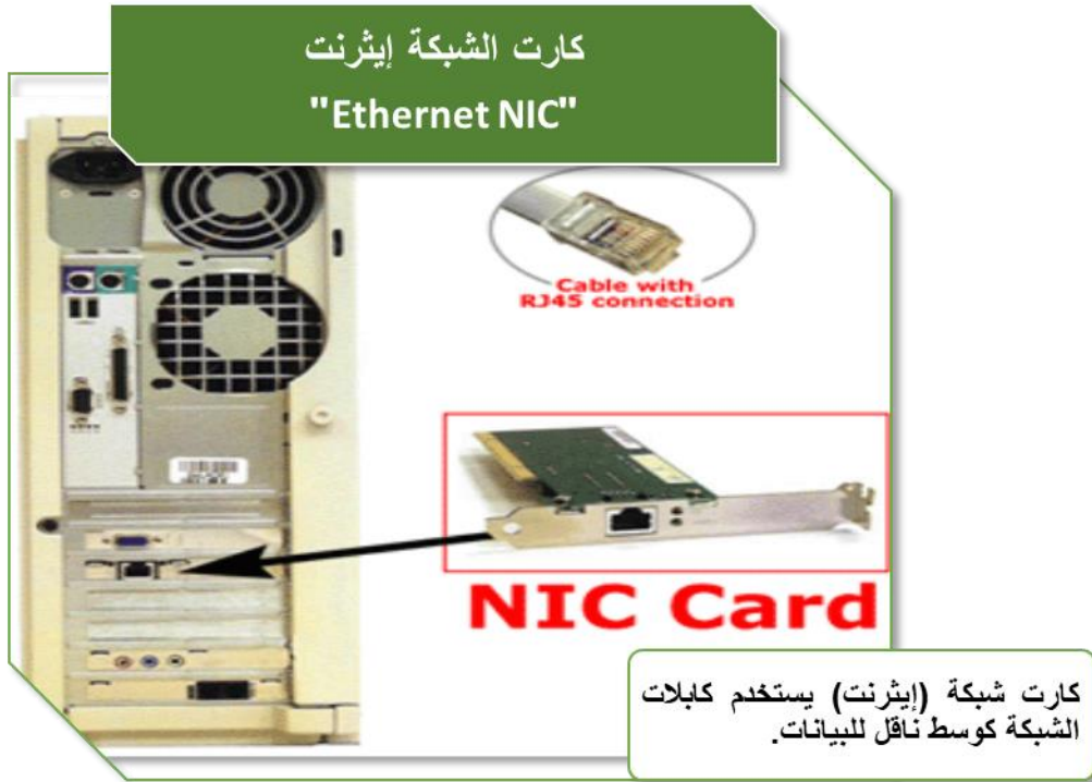
شكل رقم ٧: كارت الشبكة (إيثرنت)
