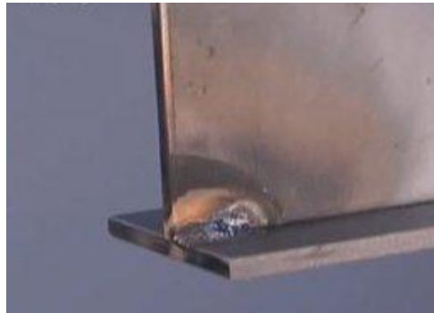
شكل ... تثبيت اطراف اللحام الداخلية
