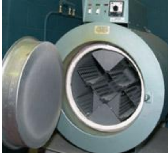
شكل ..... فرن تجفيف الالكترود Electrode Drying Oven
