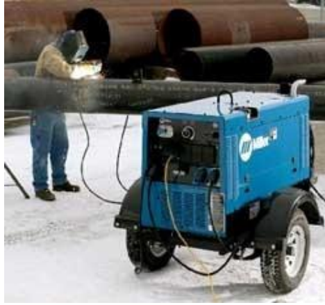
شكل .... ماكينة لحام تعمل بمولد كهربائي مدمج بها
