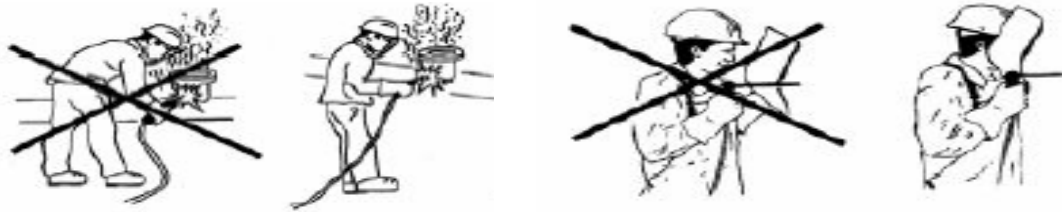
شكل .....: إختيار الوضع الصحي السليم لفنى اللحام أثناء اللحام
