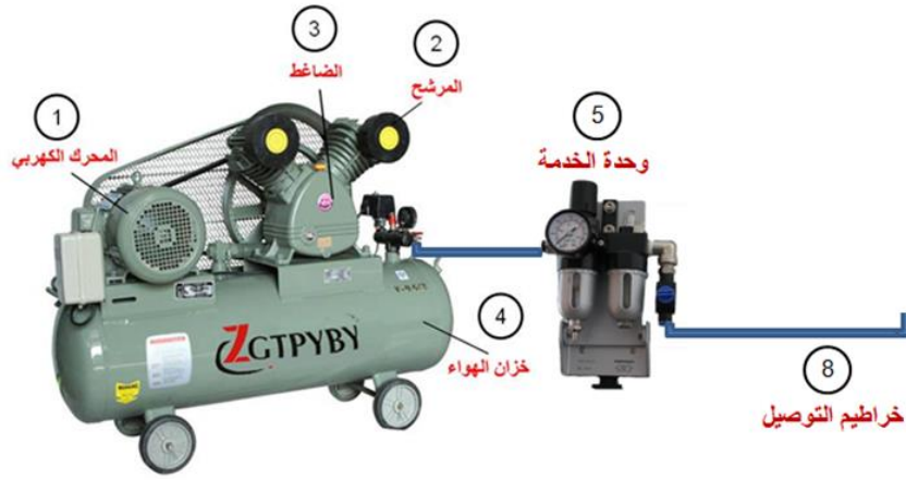
شكل رقم ١٠: ضاغط الهواء واجزاءه المختلفة
