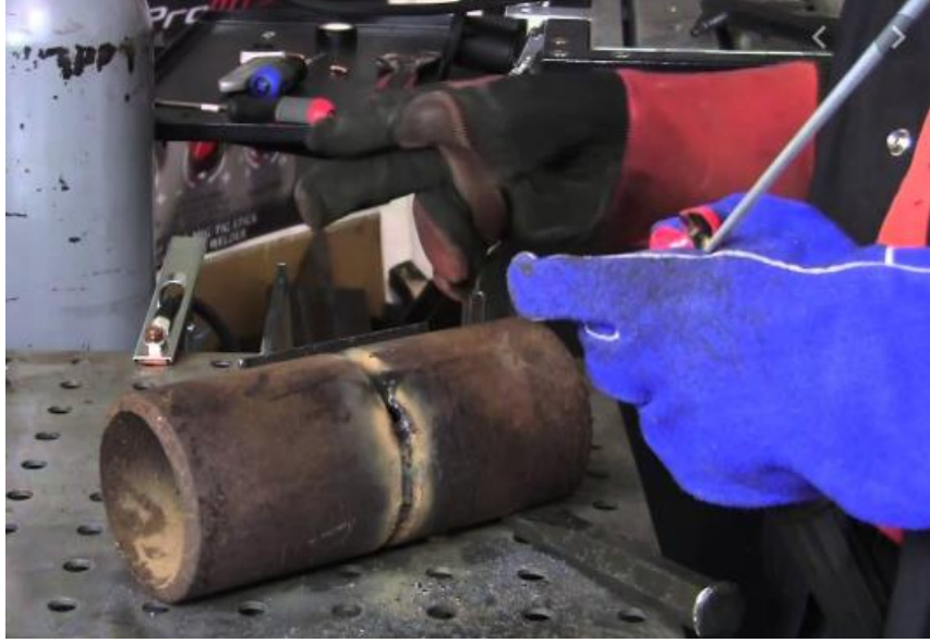
شكل رقم ٦٢: تنفيذ التثبيت بلحام القوس الكهربائي
