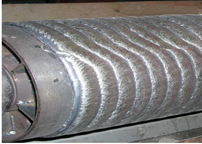
شكل رقم ٦٧: تغطية ماسورة باللحام
