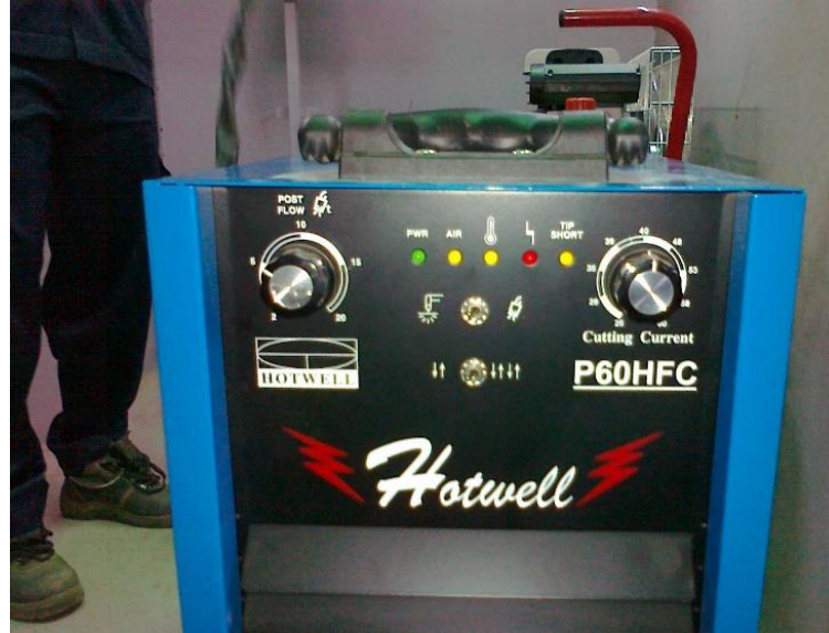
شكل رقم ٨٤: لوحة تحكم ماكينة اللحام والقطع بالبلازما
