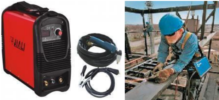
شكل رقم ٧٩: ماكينات القطع بالبلازما اليدوية من الحجم الصغير الذي تحمل على الكتف
