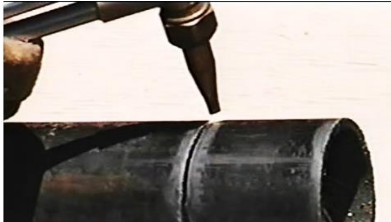
شكل رقم ١١٥: تدوير الماسورة (الأسطوانة) أثناء القطع
