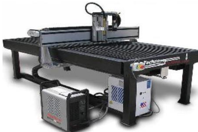
شكل رقم ٨٠: ماكينات القطع بالبلازما التي يتم التحكم بواسطة الحاسب الآلي CNC
