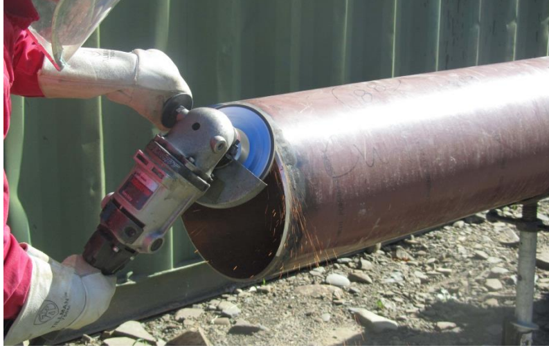
شكل رقم ٤٤: تجليخ سطح القطع
