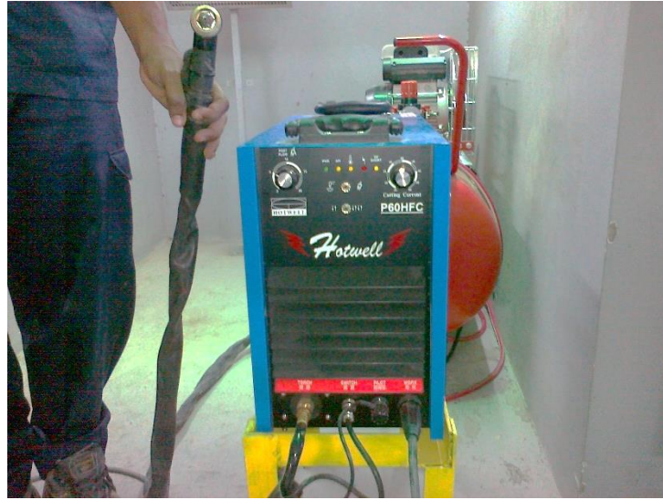
شكل رقم ٨٦: خرطوم الغاز الموصل بالماكينة والكمبروسر
