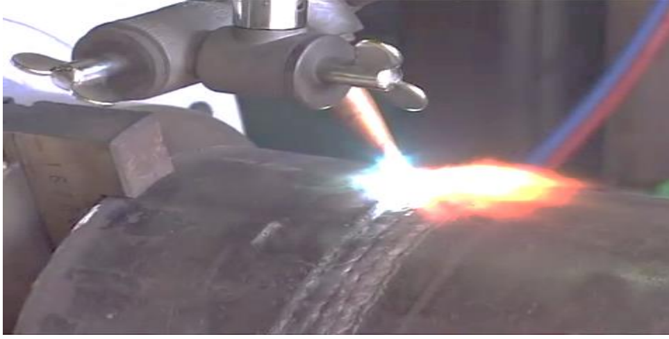
شكل رقم ٩٨: تنفيذ خط اللحام مع صهر المعدن وتدوير الماسورة ببطء بعد لحام ربع دائرة تقريبا لإكمال خط اللحام
