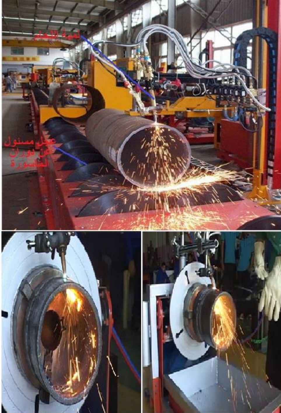
شكل رقم ٣٩: ماكينة قطع ذات لمبة لحام ثابتة
