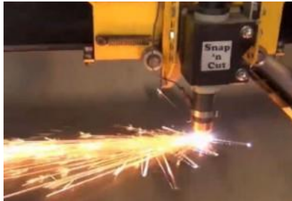
شكل رقم ٩٠: مشعل القطع الأتوماتيكي Automatic بقوس البلازما
