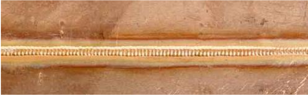
شكل رقم ٧٠: توصيل قطعتي عمل عن طريق لحام البلازما
