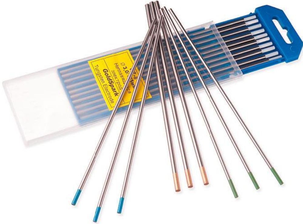
شكل رقم ١٣: أقطاب التنجستن بقطر ٣ مم وطول ٧٥ مم
