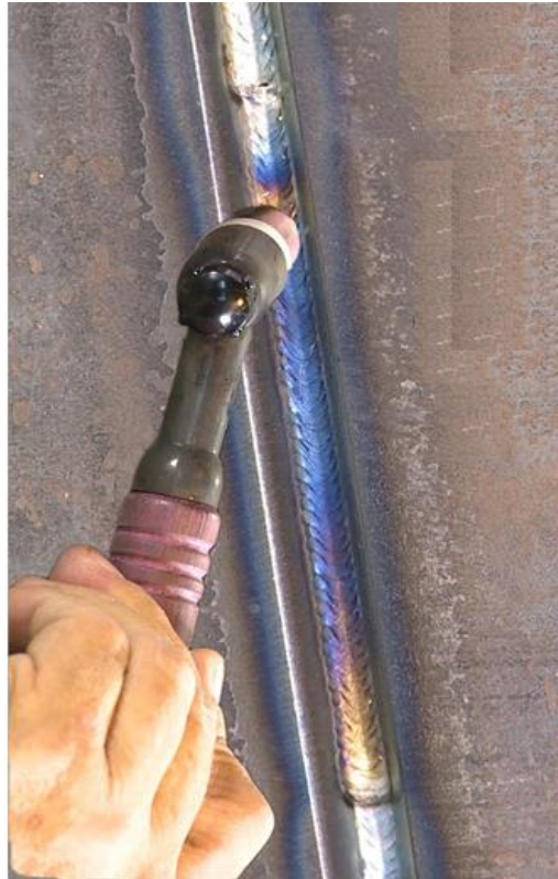
شكل رقم ١٤٥: صورة للحام التبادلي في وضع تحت مستوى النظر
