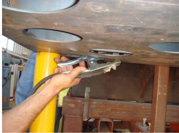
شكل رقم ١٢٣: توصيل ماسك كابل الأرضي بتزجة العمل
