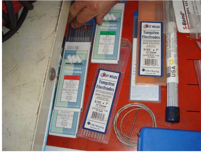
شكل رقم ٨٧: اختيار نوع قطب التنجستن
