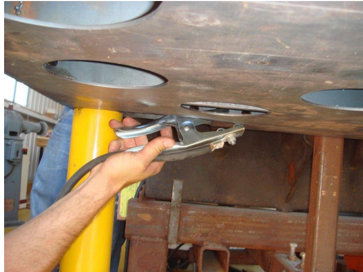
شكل رقم ١٤٢: توصيل ماسك كابل الأرضي بتزجة العمل
