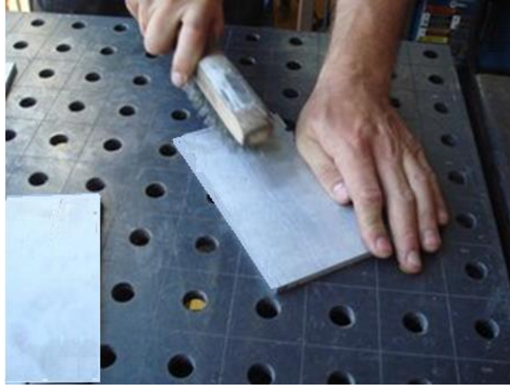
شكل رقم ١٢١: تنظيف قطعتي العمل باستخدام فرشاة سلكية
