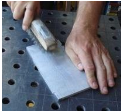
شكل رقم ١١١: تنظيف قطعة عمل باستخدام فرشاة سلكية
