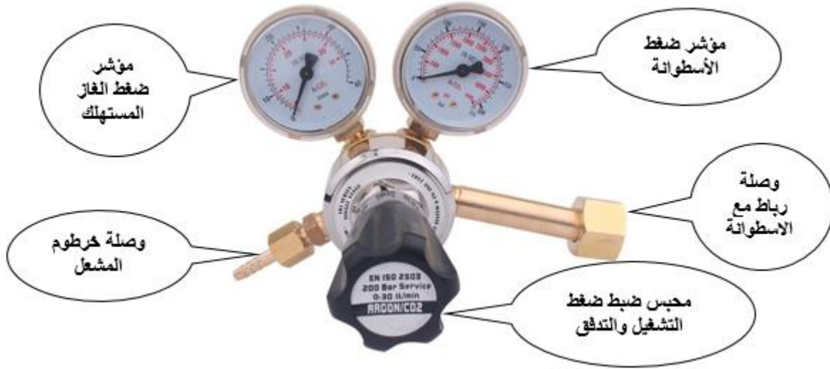
شكل رقم ٤٦: منظم ضغط غاز الأرجون /ثاني أكسيد الكربون
