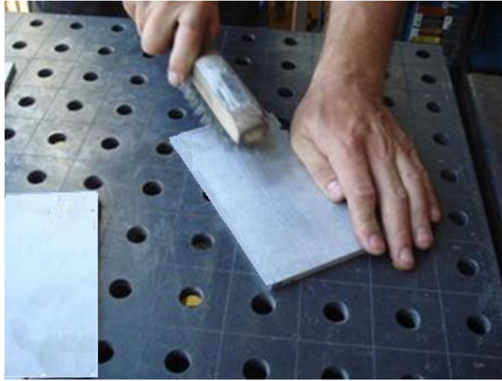
شكل رقم ١٣٢: تنظيف قطعتي العمل باستخدام فرشاة سلكية
