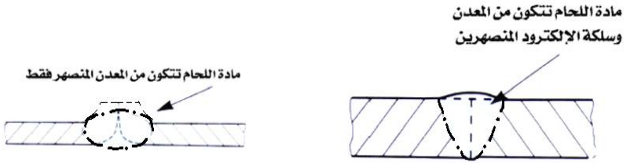
شكل رقم ٩: لحام TIG بالالكترود وبدون الالكترود
