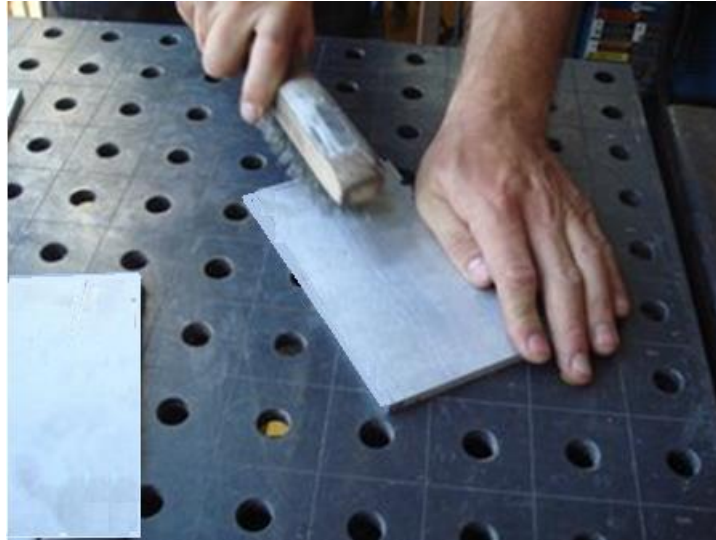
شكل رقم ١٤٠: تنظيف قطعتي العمل باستخدام فرشاة سلكية
