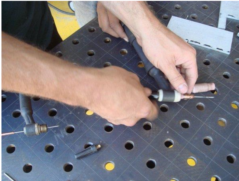
شكل رقم ٩٠: تركيب الكترود التنجستن في الطوق المعدني المخصص لذلك
