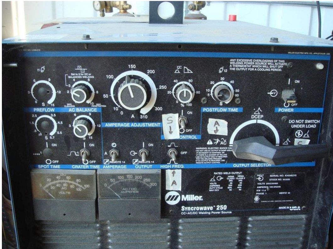
شكل رقم ٣٠: لوحة التحكم لماكينة اللحام بالأرجون
