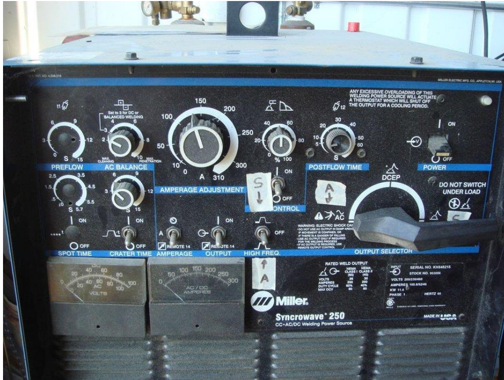
شكل رقم ٩٤: ضبط قيمة التيار ونوع التيار وشدة الغاز
