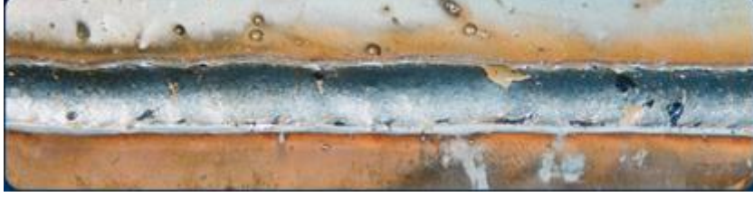
شكل رقم ٦٧: طرشة نتيجة جهد عالي مما تسبب في قوس رديء واختراق غير جيد
