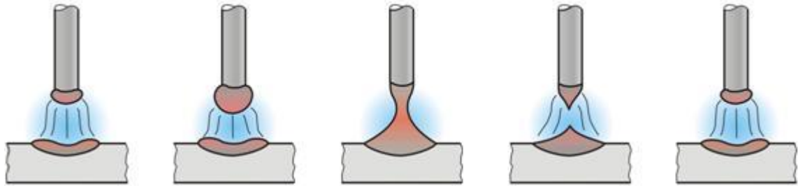
شكل رقم ٤١: مراحل انتقال انصهار سلك اللحام
