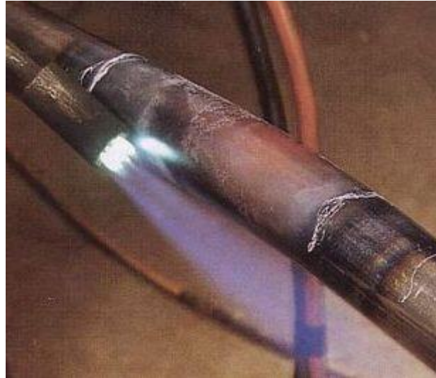
شكل رقم ٥٨: التني بالتسخين مع الرمل
