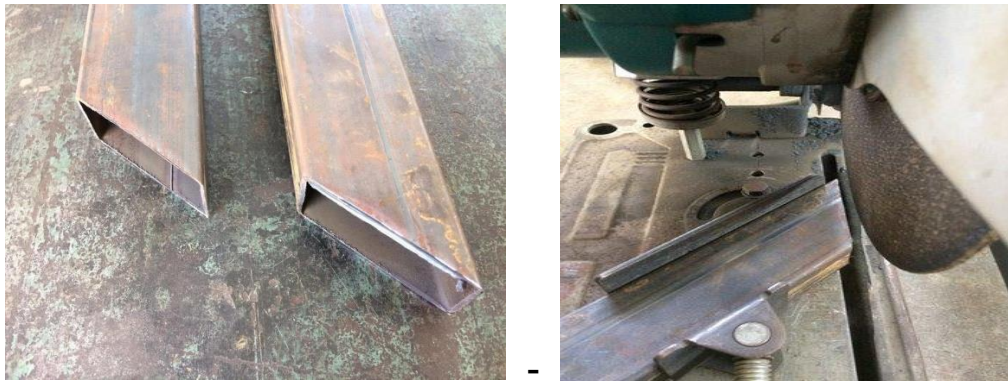
شكل رقم ١١٥: قطع العلب المفرغة بزاوية ٤٥ درجة
