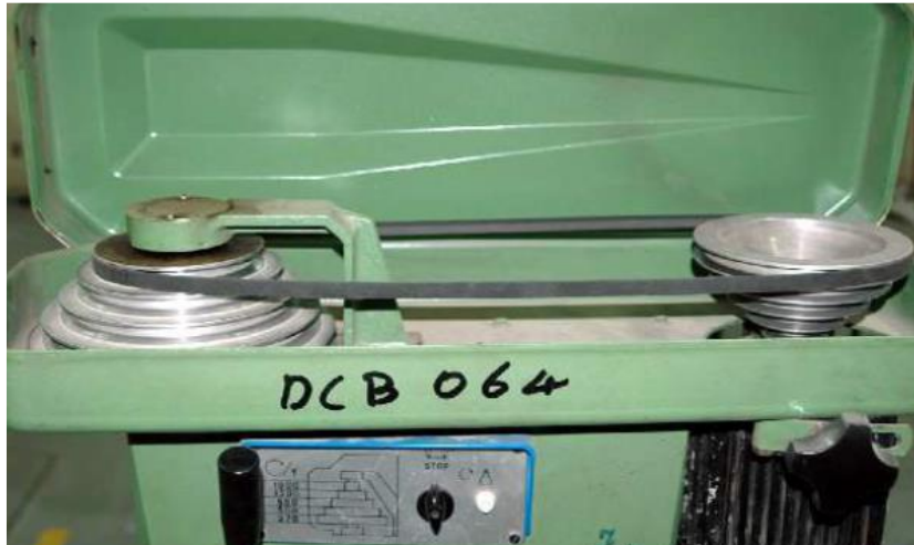
شكل رقم ٣٥: تحديد السرعة عن طريق تشغيل بكرة معينة
