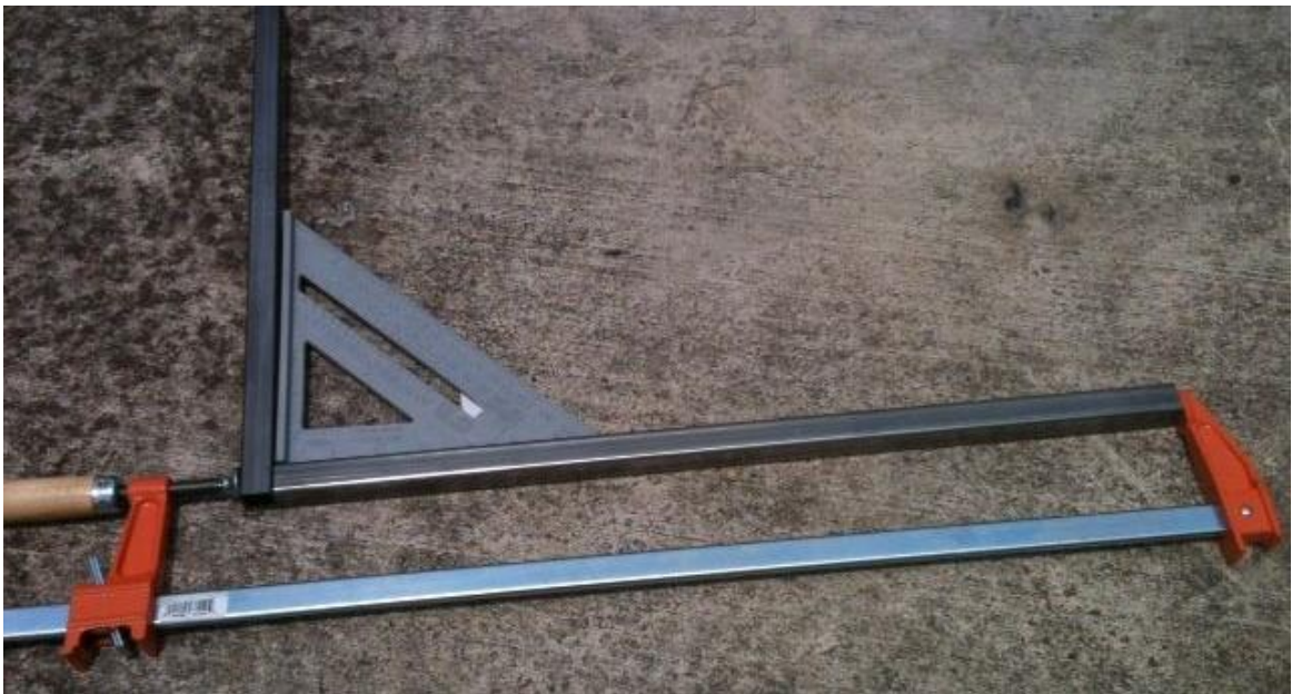
شكل رقم ١٠٦: تجميع أجزاء السلم بمساعدة الزوايا القائمة
