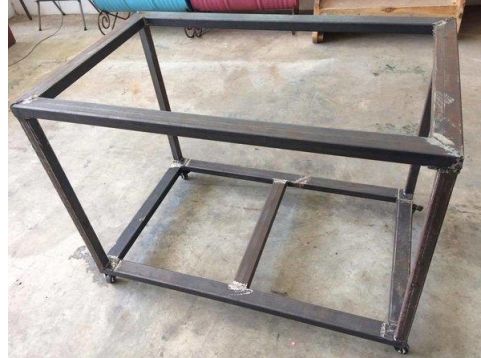
شكل رقم ١٢٢: استكمال لحام الأجزاء و تجليخ أماكن اللحام بالصاروخ
