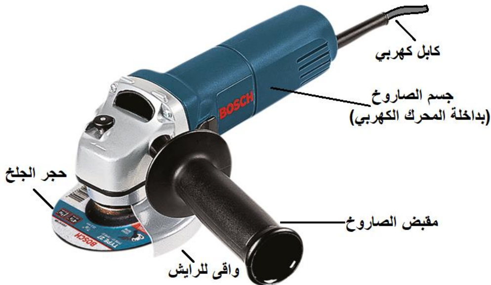
شكل رقم ٦٦: المكونات الرئيسية لآلة التجلخ المحمولة (الصاروخ) Air angle grinder
