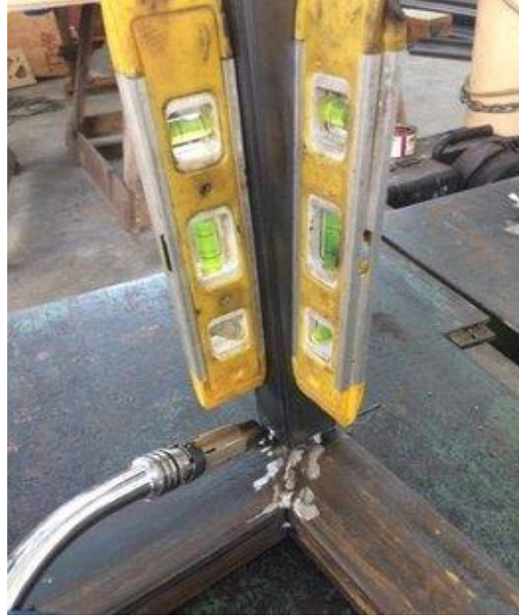
شكل رقم ١٢١: لحام الأجزاء وضبط الاستقامة بميزان المياه
