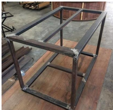
شكل رقم ١٢٢: استكمال لحام الأجزاء و تجليخ أماكن اللحام بالصاروخ
