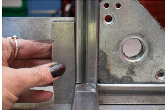
شكل رقم ١٣٧: فحص تعامد الأسطح
