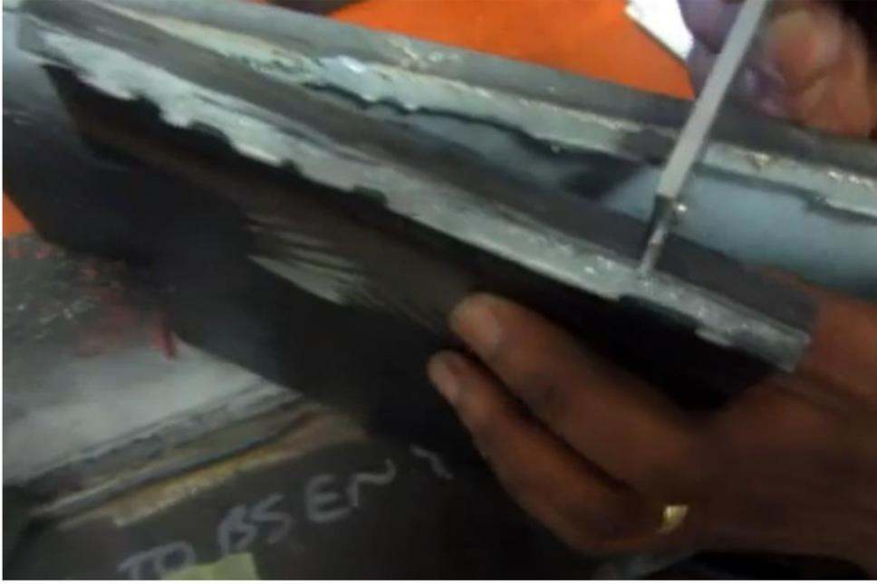
شكل رقم ٨٢: قطعة الاختبار بعد الكسر
