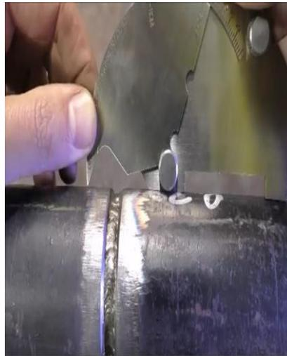
شكل رقم ١٠٧: قياس عدم المحاذاة بين أجزاء اللحام
