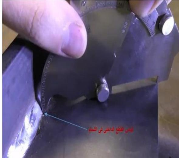
شكل رقم ١٠٦: قياس القطع الداخلي الموجود باللحام
