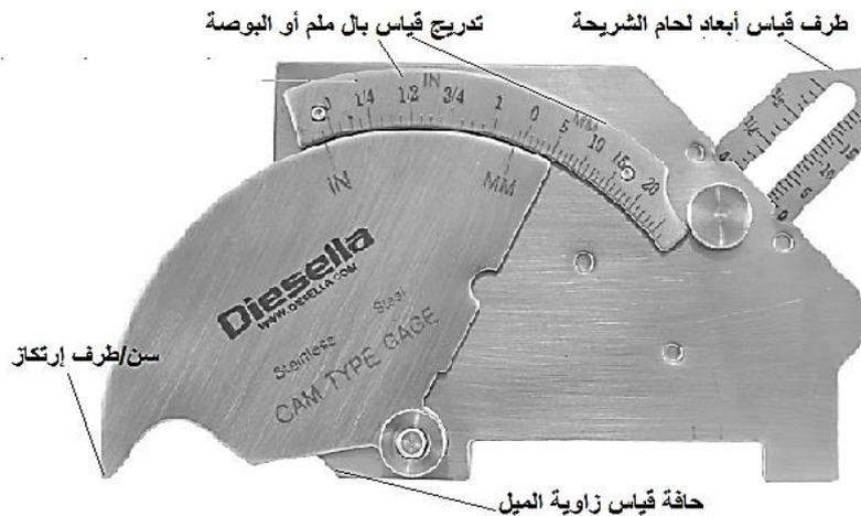
شكل رقم ٩٨: أداة قياس شكل وأبعاد اللحام
