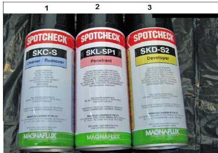
شكل رقم ١١٠: السوائل الثلاثة المستخدمة بطريقة الاختبار بالسوائل النافذة
