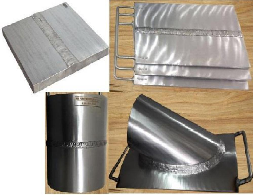
شكل رقم ١١١: العينات التي سيستخدمها الطالب في الاختبار
