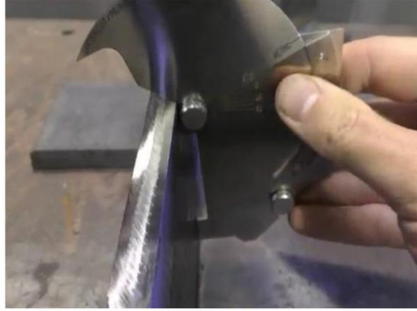
شكل رقم ١٠٨: قياس زاوية الميل
