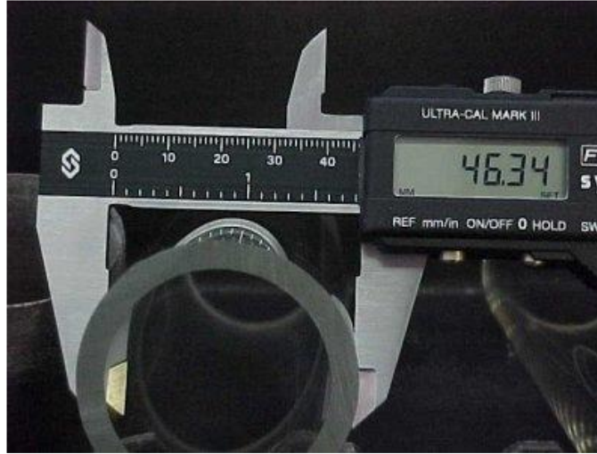
شكل رقم ٥٢: قدمه الكترونية رقمية Digital caliper
