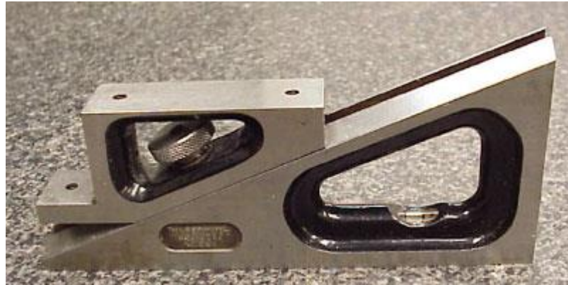
شكل رقم ١٩٥: محدد المستوي لقياس ارتفاع السطح على المقاشط
