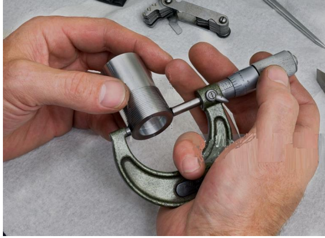
شكل رقم ٩٢: تحريك المقبض بالإبهام والسبابة مع مسك الشغلة باليد اليسرى
