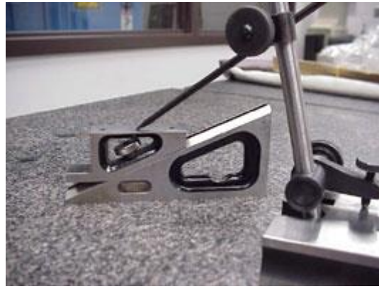
شكل رقم ١٩٧: ضبط ارتفاع شوكة العلام
