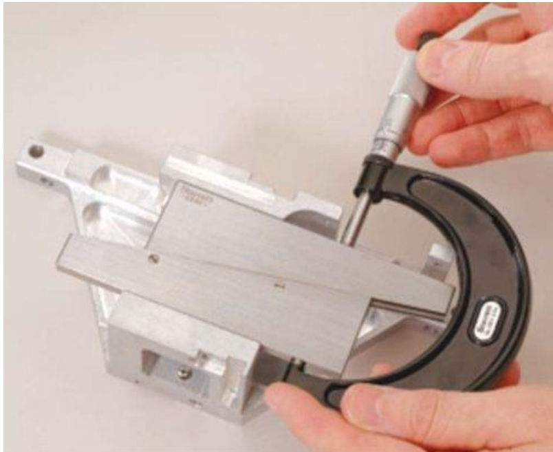
شكل رقم ١٩٣: قياس البعد المسافة الخارجية لمحدد التوازي
