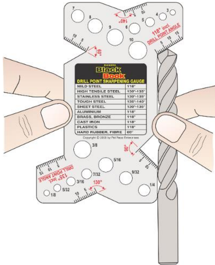
شكل رقم ١٨٣: محدد البنت الشامل لقياس البنت drill gages
