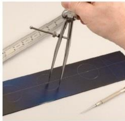
شكل رقم ٣٥: استخدامات الأنواع المختلفة من الفرجار
