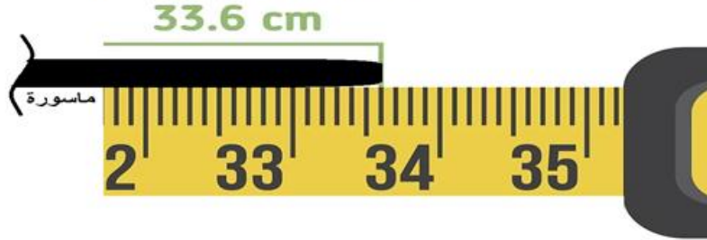
شكل رقم ٢٤: قياس طول الماسورة ٣٣,٦ سم
