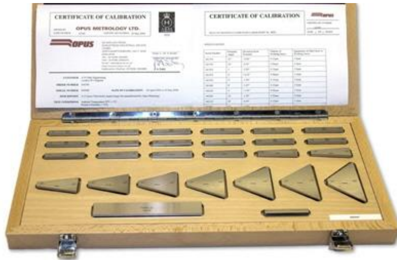
شكل رقم ١٤٣: أشكال مختلفة لقوالب قياس الزوايا (Blocks Angle Gage)
