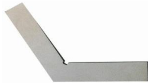
شكل رقم ١٠٨: محدد قياس زاوية منفرجة ١٢°
