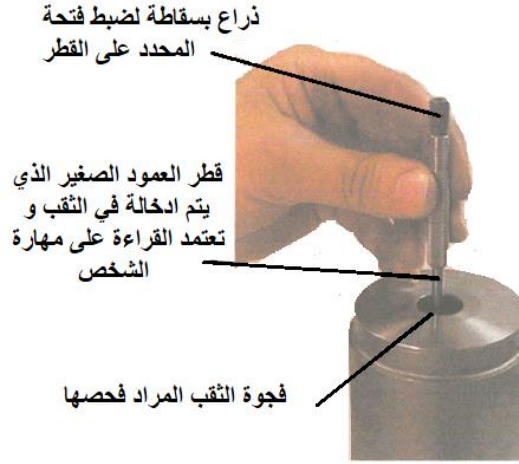
شكل رقم ١٩٩: إدخال محدد الثقوب داخل التجويف
