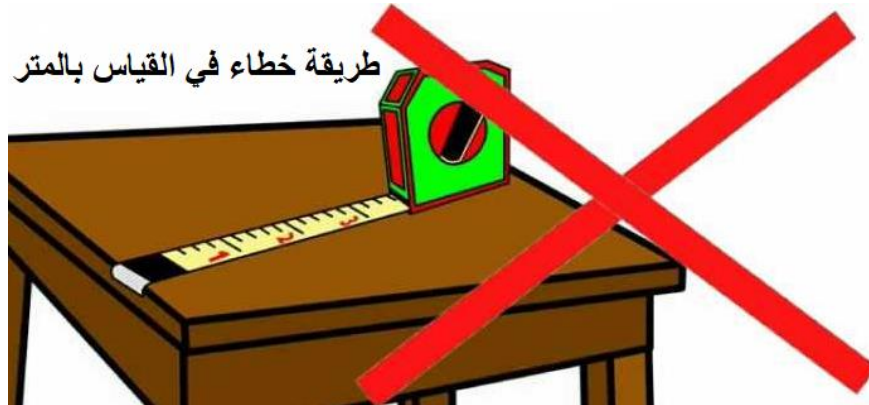
شكل رقم ٢٢: تأكد من تعامد بداية طرف المتر على السطح المراد قياسه
