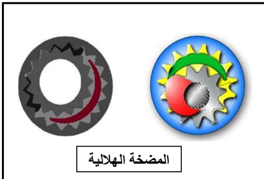
شكل (٦-٤-أ) المضخة ذات التروس
