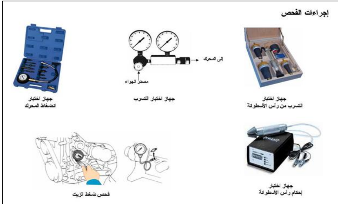
شكل ( ١ - ١٠٦ ) بعض أجهزة فحص المحرك
