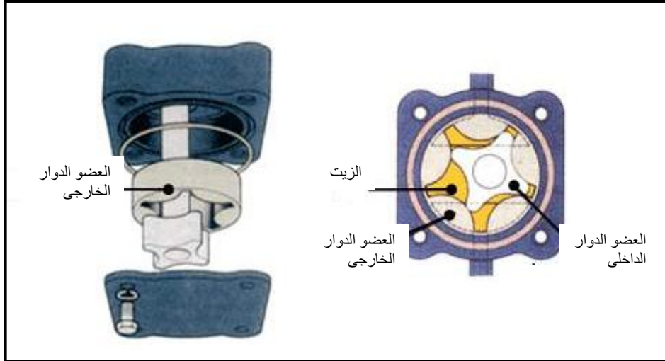
شكل (٦-٤-أ) المضخة ذات التروس
