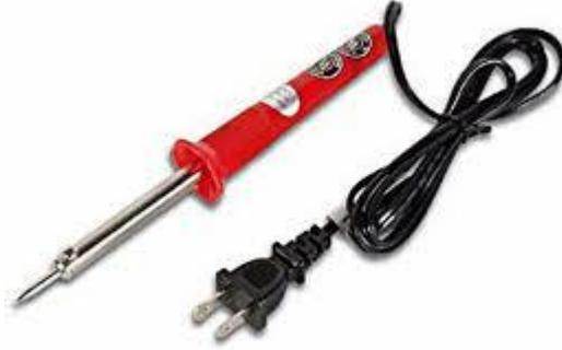
وهى عبارة عن مقبض معزول من البكالييت وماسورة يمر خلالها الموصل الكهربى وإنتفاخ معدنى بداخله ملف من النيكل كروم ومعزول بالفخار وتنتهى أيضاً بسلاح من النحاس الأحمر (أداة اللحام)، وتستخدم فى لحام الأطراف أو نهايات الأسلاك بالقصدير ولحام الأطراف الكهربائية بعضها ببعض أحياناً.
