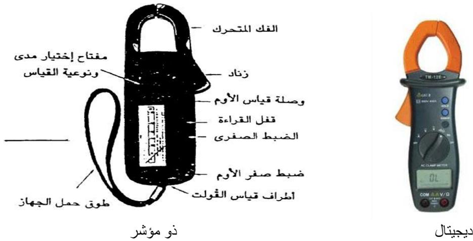
ويفضل إستخدام هذه الأجهزة فهي لا تحتاج إلى توصيلات سلكية عند قياس شدة التيار الكهربى (A) تيار متغير وتقيس الضغط الكهربى (V) حتى 600 فولت، وتقيس المقاومة الكهربائية ( $\Omega$ ) بتدرج واضح للمقاومات الصغيرة لتناسب إستعمالات أنظمة التبريد.
