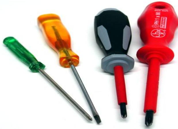
وهى مفكات متعددة الأشكال وذلك لتعدد الأغراض التى تستخدم فيها وكل شكل منها يستخدم فى غرض معين وهى متشابهة تقريباً من حيث التركيب وهى عبارة عن مقبض (يد) مصنوع من مادة عازلة ويكون الإختلاف عموماً فى شكل السلاح فقط حيث أن هناك مليون طرفه مبسط وما يكون على شكل صليبية وآخر بسن مدبب، وكل منها يكون إستخدامه تبعاً لشكل المشقبة الخاصة بالمسمار المراد ربطه أو فكه.
