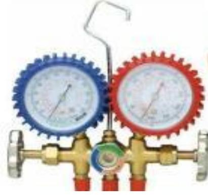
شكل (7) مانومتر قياس الضغط
