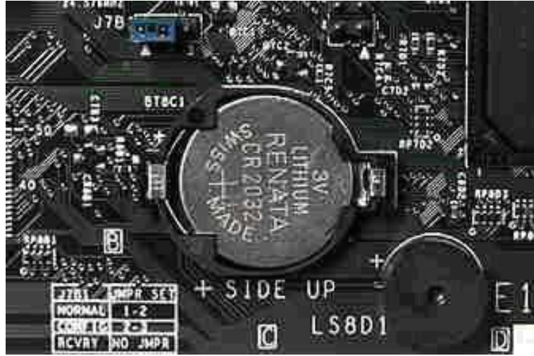
شكل رقم ٢٢: بطارية CMOS على اللوحة الأم
