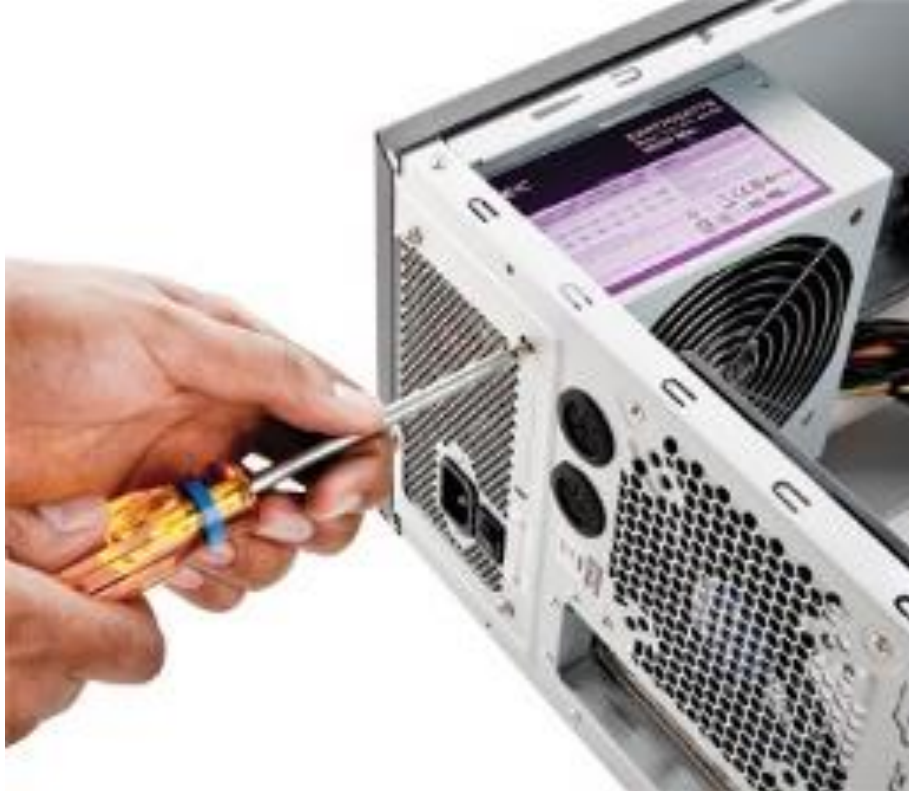
شكل رقم ٦٤: تثبيت مصدر التغذية (Power Supply)
