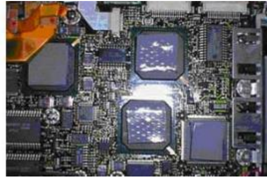
شكل رقم ٢٣: شرائح التحكم على اللوحة الأم
