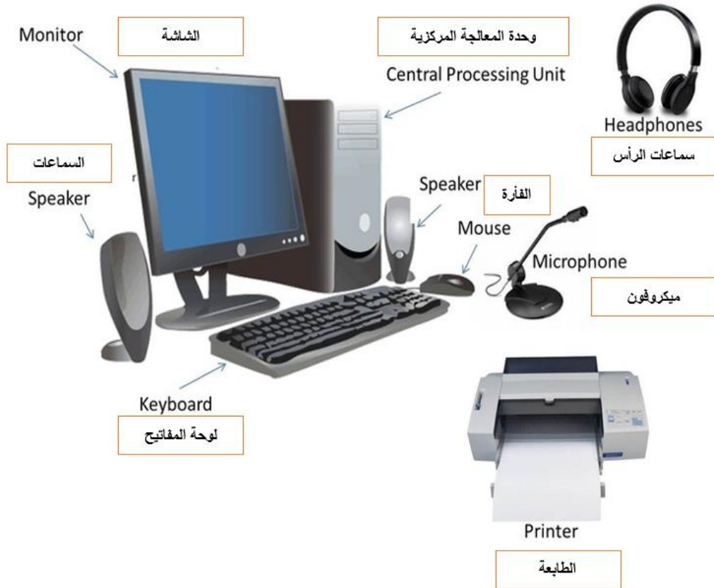
شكل رقم ١: أجزاء الحاسوب
