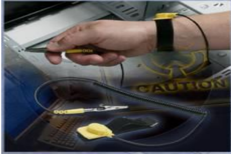
شكل رقم ٤٦ : كيفية ارتداء سوار المعصم وتوصيله بالأرضي
