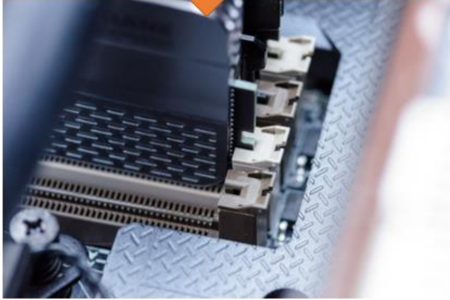
شكل رقم ٩٩: تثبيت الذاكرة في الفتحة المخصصة لها
