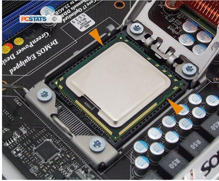
شكل رقم ٨٤: محاذاة المعالج الدقيق (Notch)
