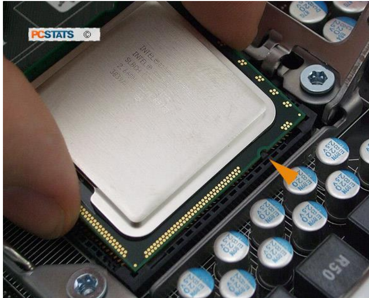
شكل رقم ٨٣: محاذاة المعالج الدقيق (Notch)
