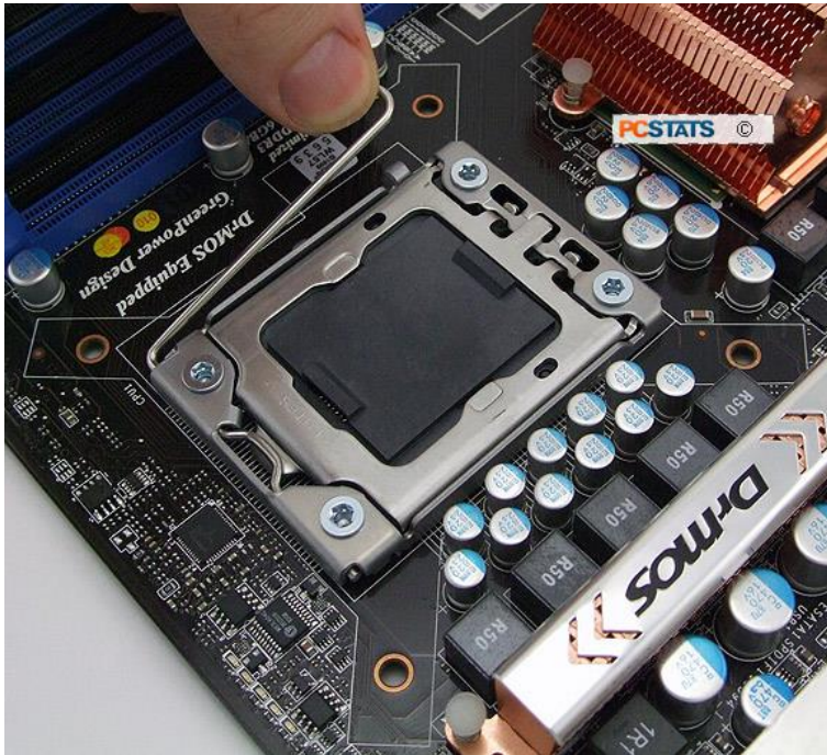
شكل رقم ٧٩: رفع الزراع المعدني لمثبت المعالج
