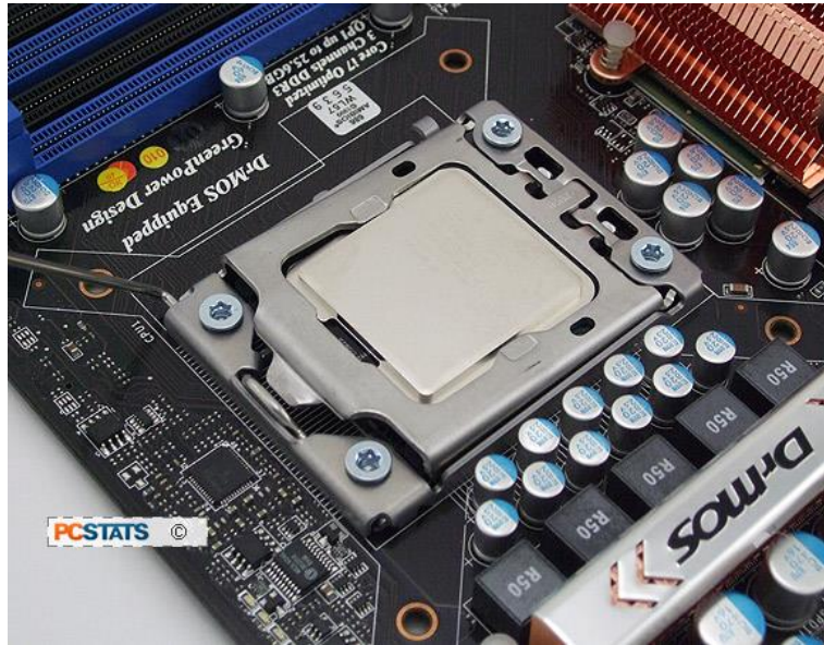
شكل رقم ٨٥: غلق الغطاء المعدني فوق المعالج الدقيق
