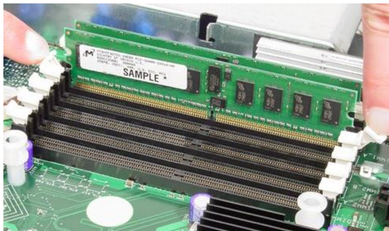
شكل رقم ٧١: شق تركيب الذاكرة العشوائية (Slot)
