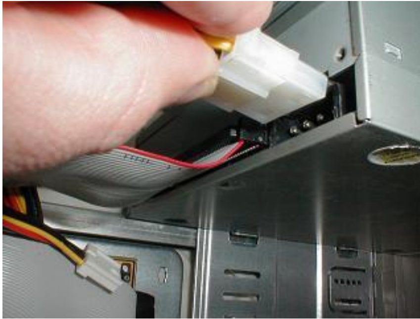
شكل رقم ١١١: توصيل كابل التغذية بمؤخرة محرك الأقراص الضوئية أو الليزرية أو المدمجة
