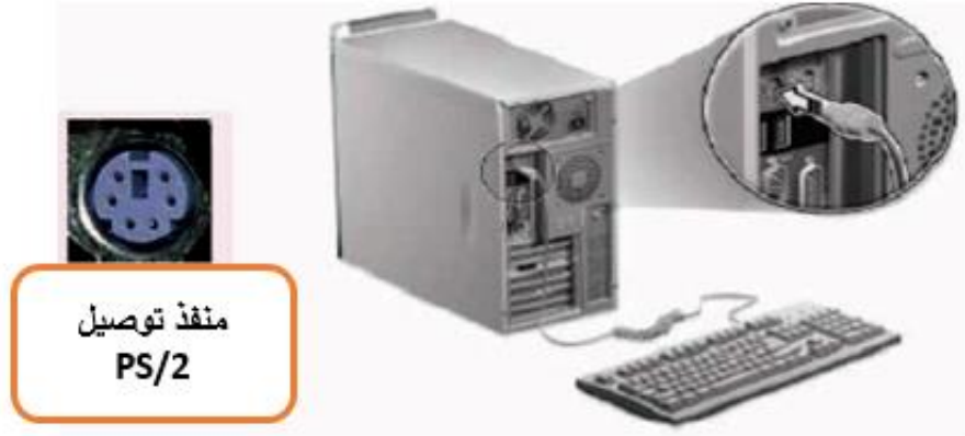
شكل رقم ١٧٢: توصيل لوحة المفاتيح (PS/2)
