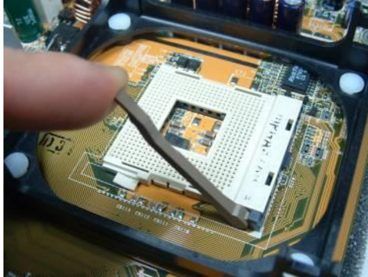
شكل رقم ٧٣: رفع الذراع لتجهيز القاعدة لتثبيت المعالج
