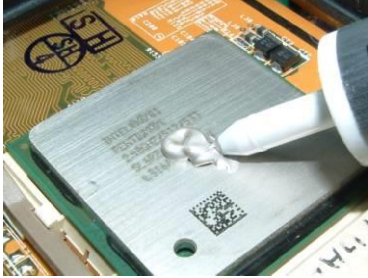
شكل رقم ٧٦: حقن المركب الحراري (معجون التبريد) بين المشتت والمروحة من ناحية وبين جسم المعالج من ناحية أخرى
