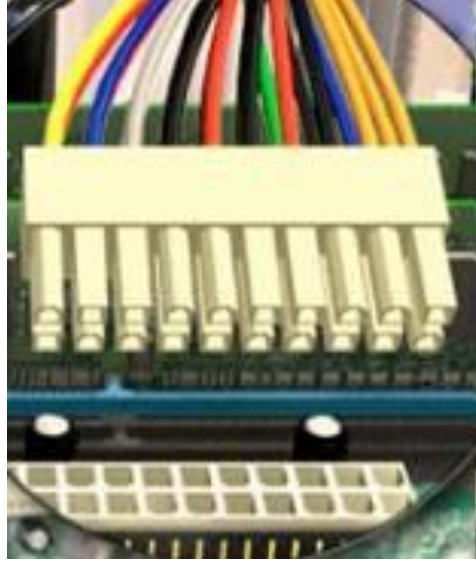
شكل رقم ١٤١: موصل ATX والشق المناسب له في اللوحة الأم
