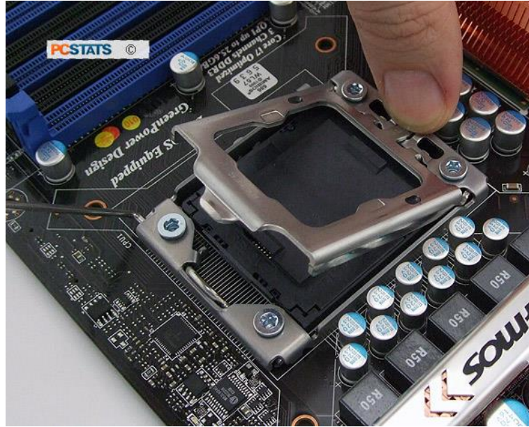
شكل رقم ٨١: رفع الغطاء المعدني
