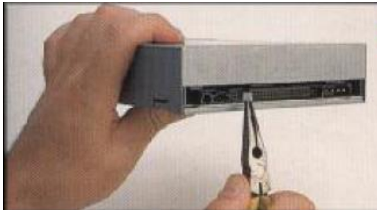
شكل رقم ١٢١: ضبط محرك الأقراص الليزرية أو الضوئية أو المدمجة على الوضع تابع (Slave)
