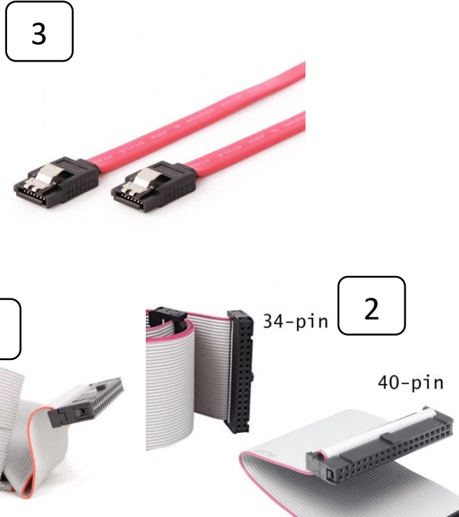
شكل رقم ١٤٧: شكل يوضح الأنواع الثلاثة لكابلات البيانات: (١) كابل بيانات محرك الأقراص المرنة (٢) كابل بيانات PATA لمحرك الأقراص الصلبة أو الضوئية من النوع IDE (٣) كابل بيانات SATA لمحرك الأقراص الصلبة أو الضوئية من النوع SATA
