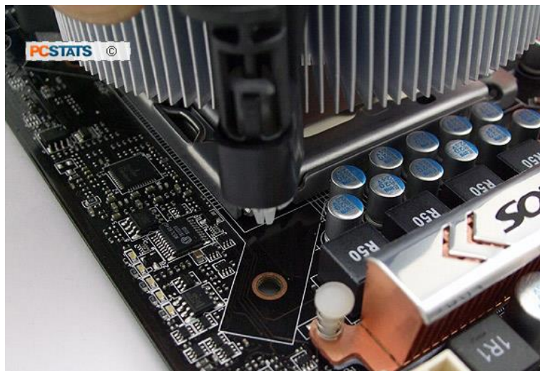
شكل رقم ٩٠: تثبيت المروحة والمشتت الحراري
