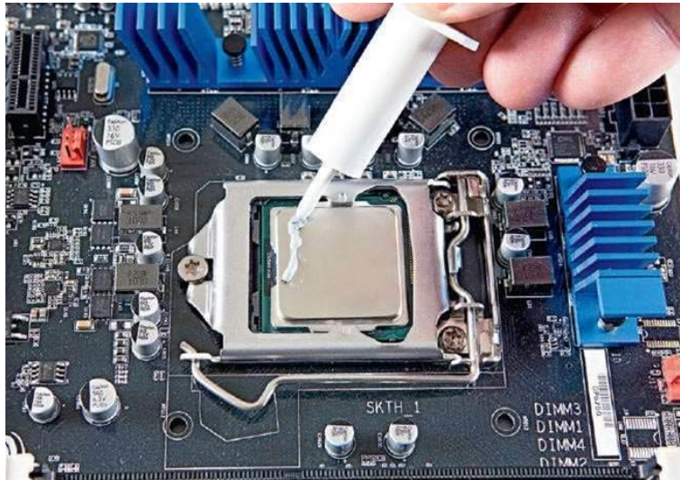
شكل رقم ٨٧: حقن المركب الحراري بين المشتت والمروحة من ناحية وبين جسم المعالج من ناحية أخرى
