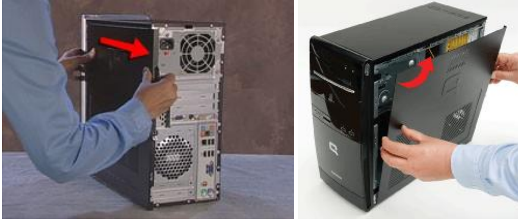
شكل رقم ٦١: إحدى طرق فتح الصندوق Case
