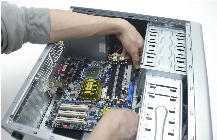
شكل رقم ١٠٢: تثبيت اللوحة الأم بالمسامير المخصصة
