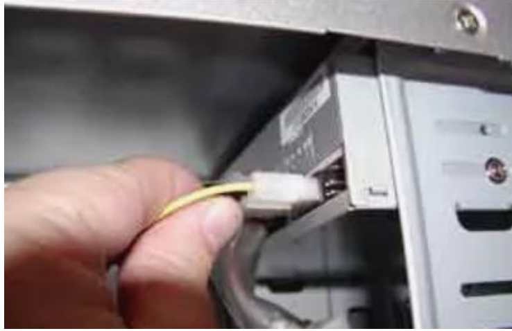
شكل رقم ١٥٠: توصيل موصل الطاقة Molex لمحرك الأقراص الضوئية
