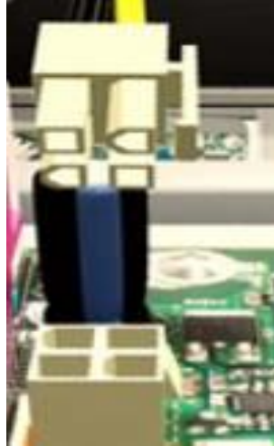
شكل رقم ١٤٢: موصل (AUX – ATX 12) والشق المناسب له في اللوحة الأم
