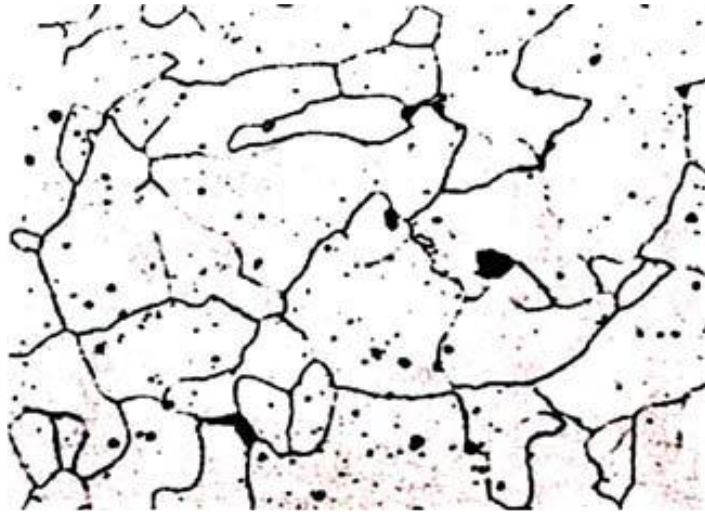
شكل رقم ١٣٢: البنية المجهرية للحديد الزهر الطروق الأبيض
