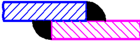
شكل رقم ١٨٠: المسقط الرأسي لوصلة لحام تراكبية
