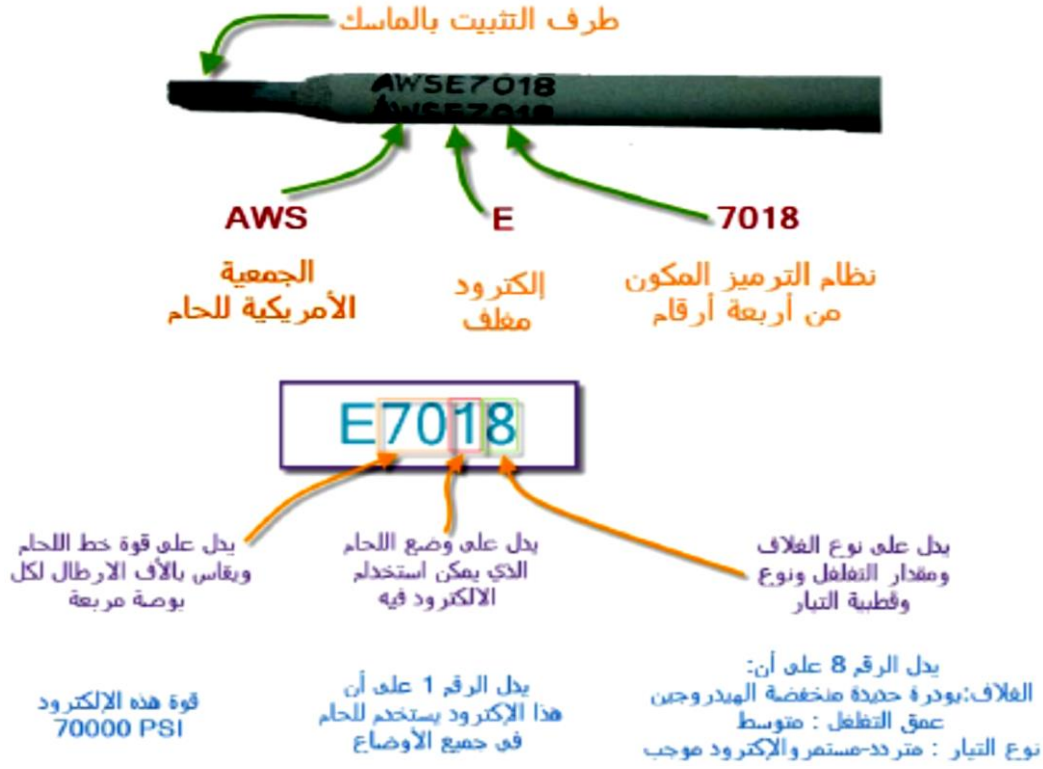
شكل رقم ٧٨: نظام ترميز الإكترودات اللحام
