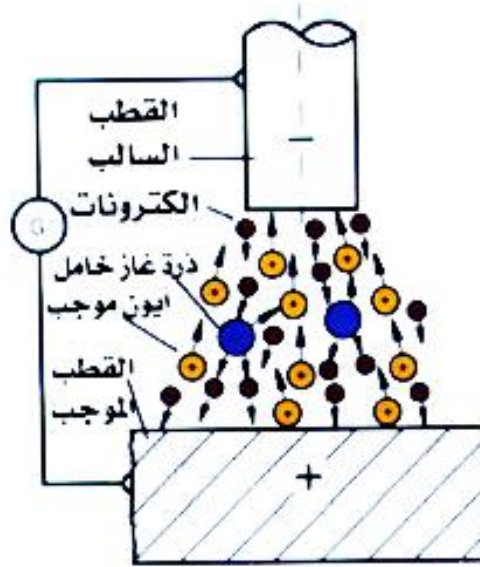
شكل رقم ٢٦: التأثير الحرارى للقوس الكهربى
