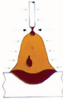
شكل رقم ٣٢: تابع وصف إنصهار سلكة اللحام في MAG/MIG
