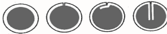
أشكال المقاطع لسلك flux cord wire
