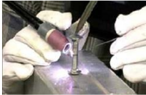
شكل رقم ٩٤: عملية اللحام بالتيج
