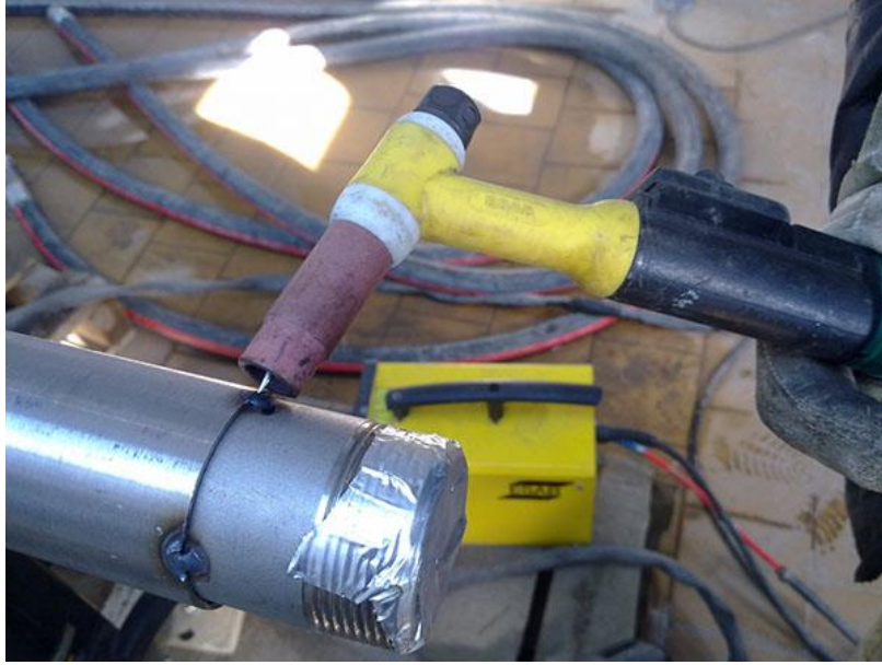
شكل رقم ٨٢: لحام التيج لمواسير الصلب الذي لا يصدأ
