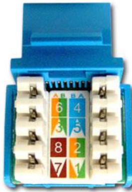
شكل رقم ١٣٩: ترتيب الألوان حسب الترتيب القياسي (EIA/TIA A, B) صورة أفقية لمقبس RJ45
