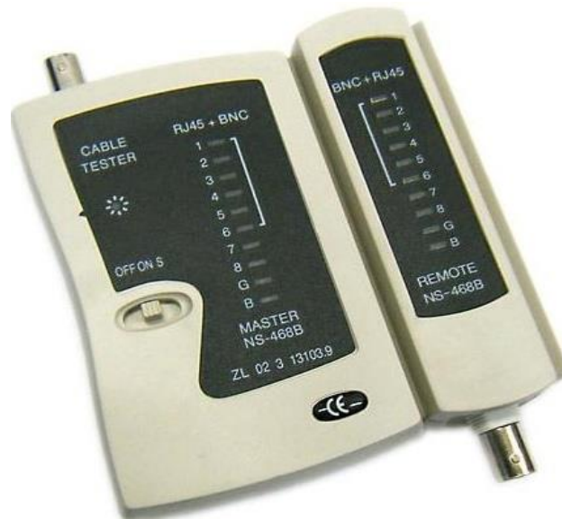
شكل رقم ١٠٥: فاحص كابل الشبكة من نوع الكابل المحوري (Coaxial Cable)
