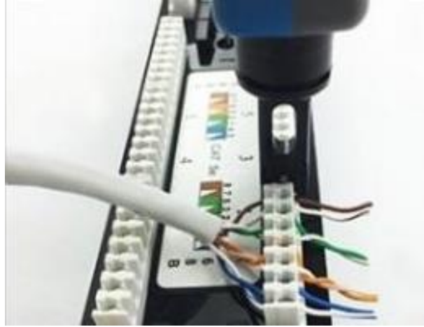
شكل رقم ١٣٢: عملية تدبيس السلك في المكان المخصص
