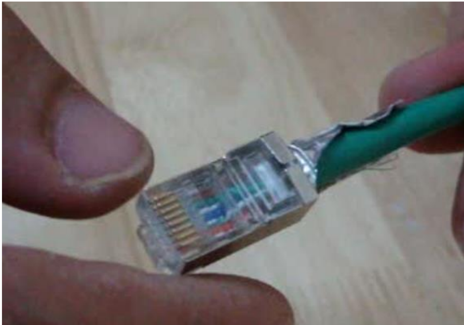
شكل رقم ٩٨: اتصال الغلاف المعدني للكابل (FTP) مع الغلاف المعدني بالموصل RJ45
