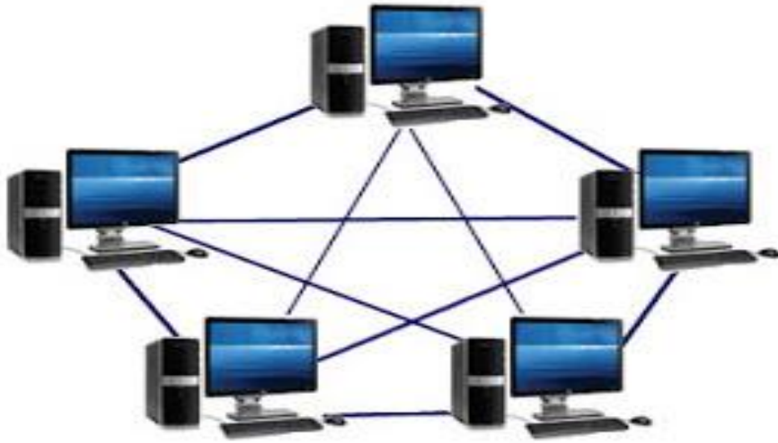
شكل رقم ٩: توصيل بالأسلوب الشبكي
