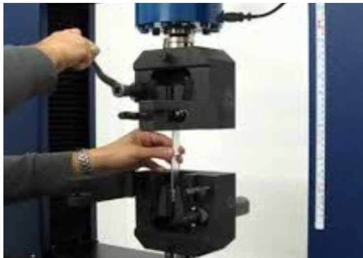
شكل رقم ٧٩: تركيب عينة على الجهاز العام للتجارب
