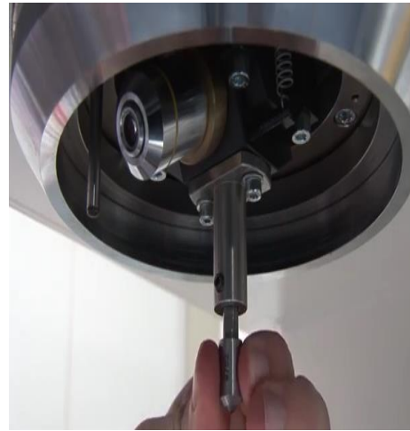
٤. ركب المسنن الذي تم اختياره بالجهاز
