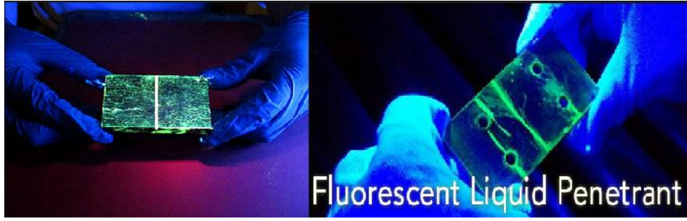
شكل رقم ٩٥: نتائج استخدام طريقة المظهر الفلوري.
