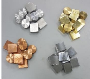
شكل رقم ٦٥: عينات مربعة ودائرية الشكل من الحديد الطري والحديد الزهر والنحاس الأحمر والأصفر.
