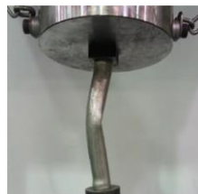
شكل رقم ٣٨: عينة نسبة الطول إلى القطر &lt; ١٠ تعرضت للانبعاج
