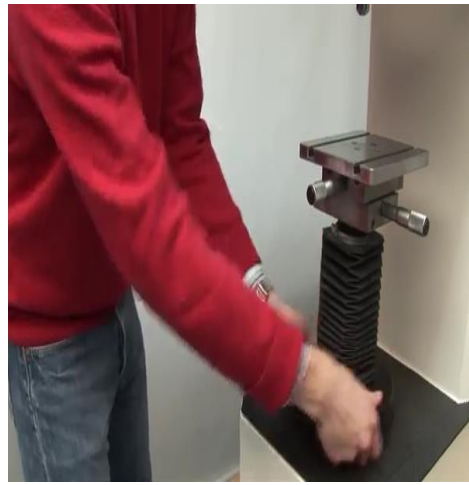
٥. لف عجلة اليد لرفع سندان تثبيت العينة ليكون في وضع مناسب لكلا من الميكروسكوب والمسنن
