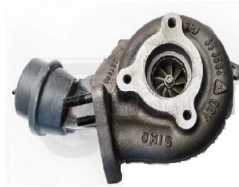
شكل رقم ٦٤: جهاز الشاحن الجبري "Turbocharger"
