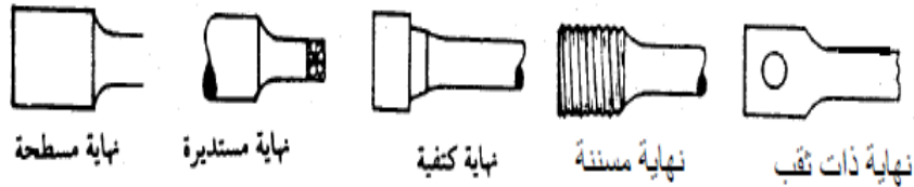
شكل رقم ٢٢: نهايات مختلفة لعينات قياسية لاختبار الشد
