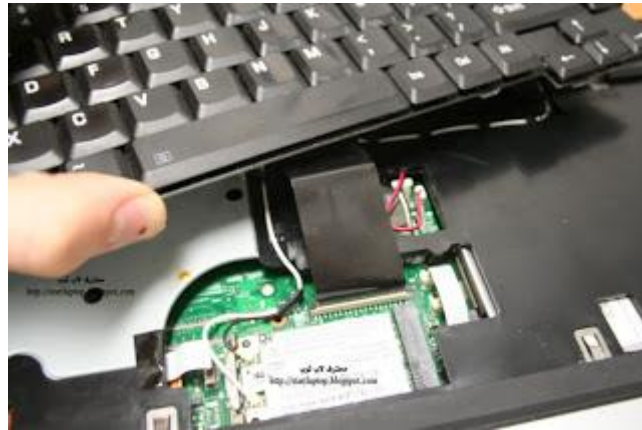
شكل رقم ٥٩: فك لوحة المفاتيح لجهاز الحاسب المحمول
