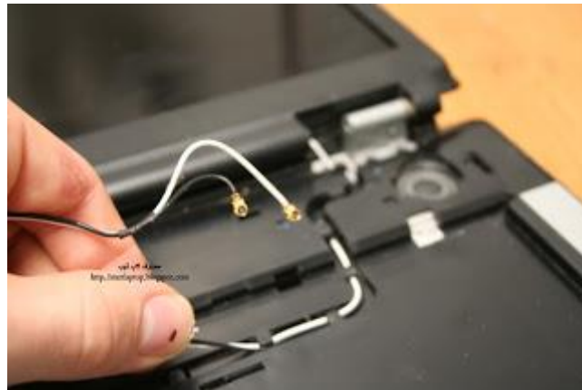
شكل رقم ٦٠: فك كابلات الشاشة والوير لس لجهاز الحاسب المحمول
