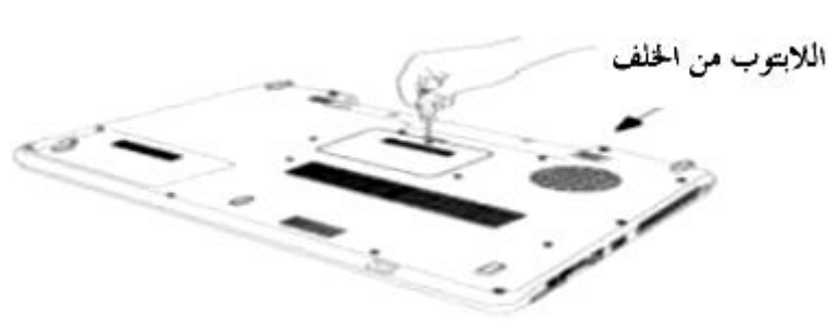
شكل رقم ٦٤: فك غطاء وحدات الذاكرة من الخلف
