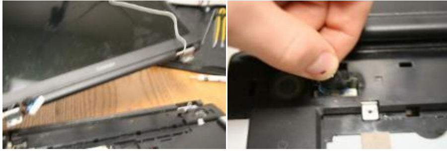
شكل رقم ٦١: فك الشاشة لجهاز الحاسب المحمول
