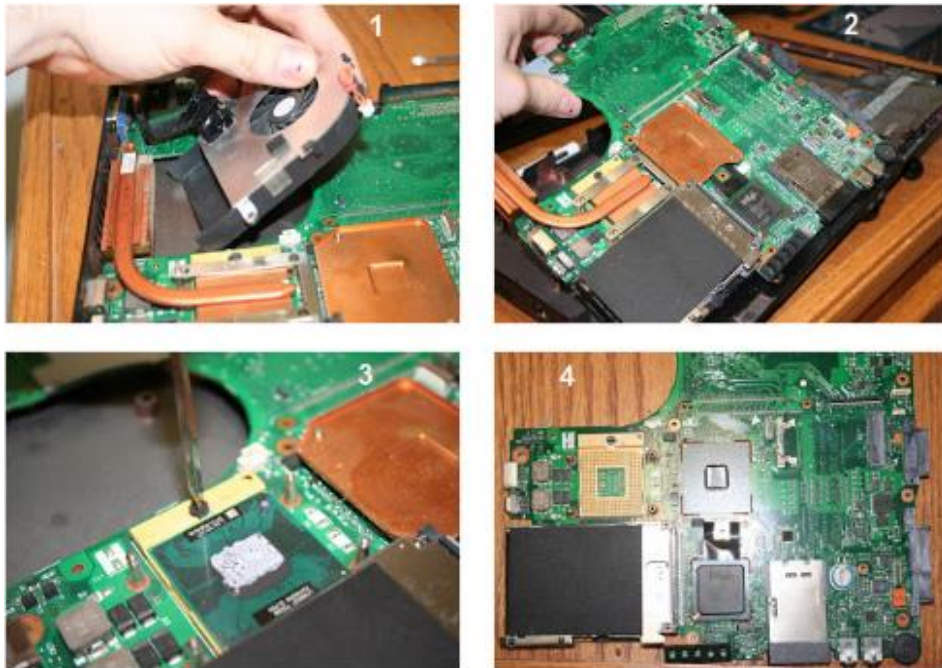
شكل رقم ٦٣: فك مروحة التبريد والمعالج لجهاز الحاسب المحمول
