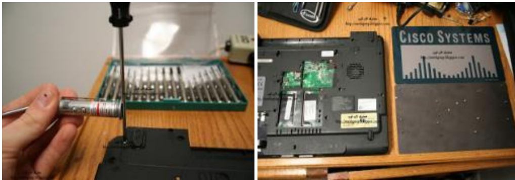
شكل رقم ٥٧: فك مسامير الناحية السفلية للحاسب المحمول
