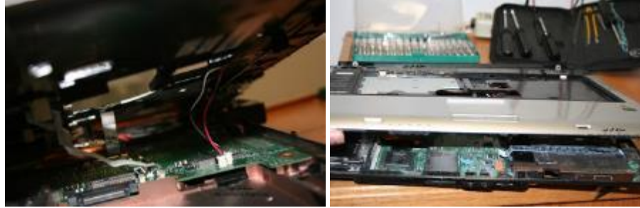
شكل رقم ٦٢: فك الجزء العلوي والغلاف لجهاز الحاسب المحمول
