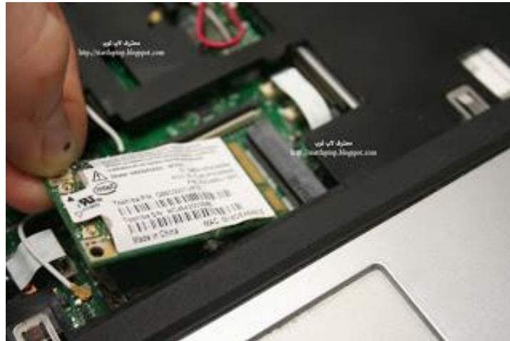
شكل رقم ٥٥: اخراج بطاقة الشبكة اللاسلكية من الحاسب المحمول
