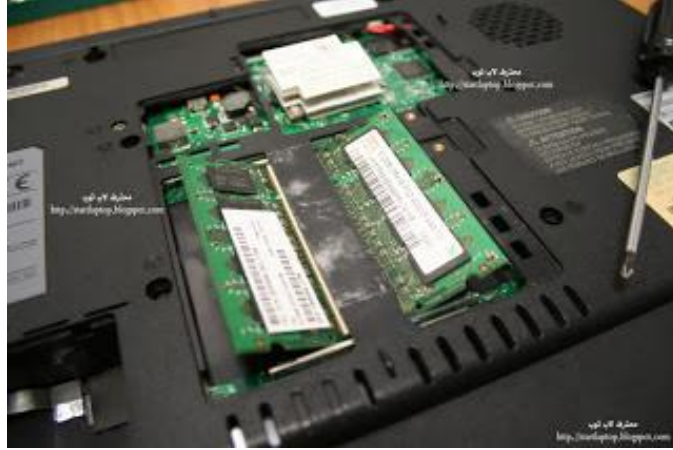
شكل رقم ٥٤: اخراج الذاكرة RAM من الحاسب المحمول
