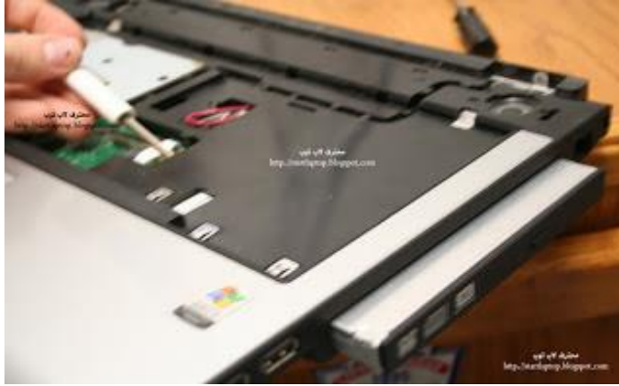
شكل رقم ٥٦: اخراج محرك الأقراص الضوئية من الحاسب المحمول
