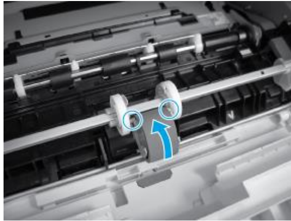
شكل رقم ٢٦: تركيب الأسطوانة
