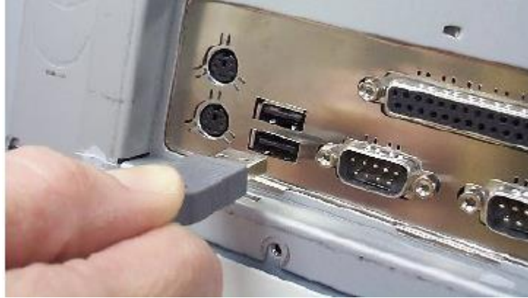
شكل رقم ١٧: منفذ وكابل وكيفية توصيل USB
