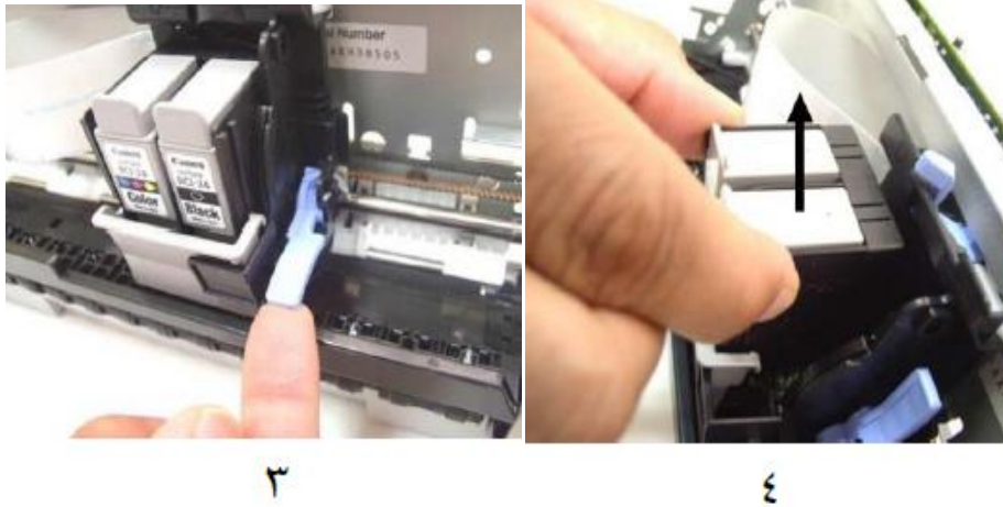
شكل رقم ٨: إزالة حاويات الحبر الفارغة
