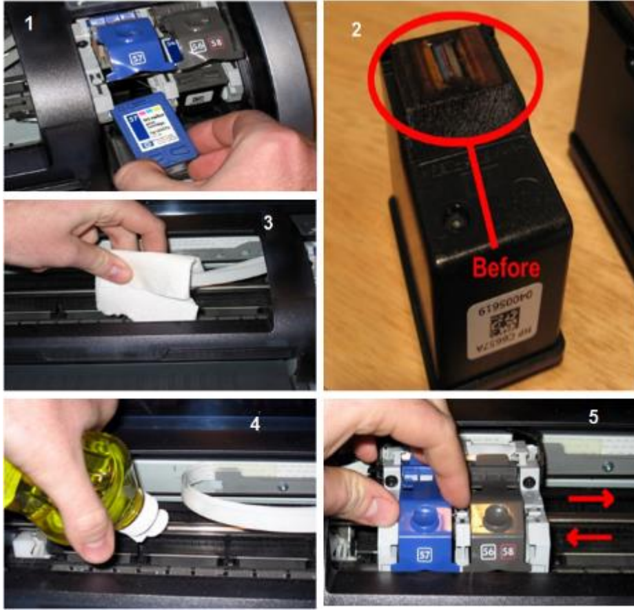
شكل رقم ٤٦: مراحل تنظيف الطابعة النافثة للحبر
