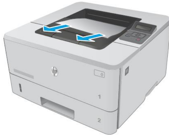
شكل رقم ٣٨: ازالة الورق المنحشر ظاهريا
