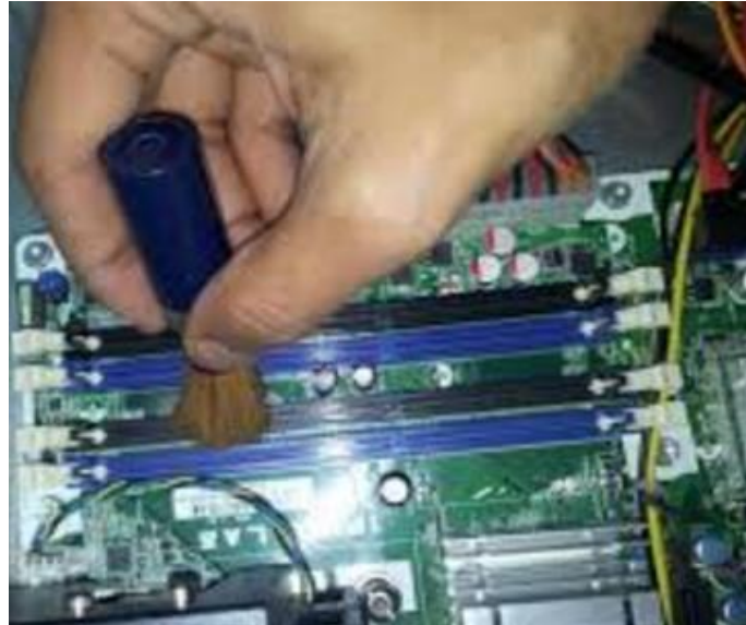
شكل رقم ١٠٢: تنظيف اللوحة الام بالفرشاة
